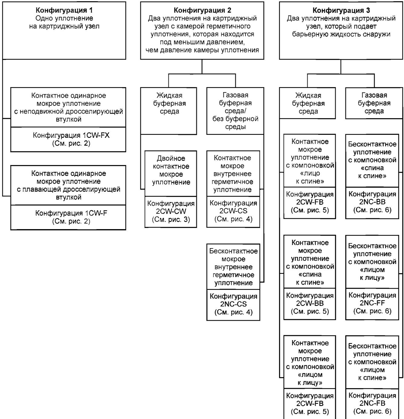
Рисунок 1 — Конфигурация уплотнения
