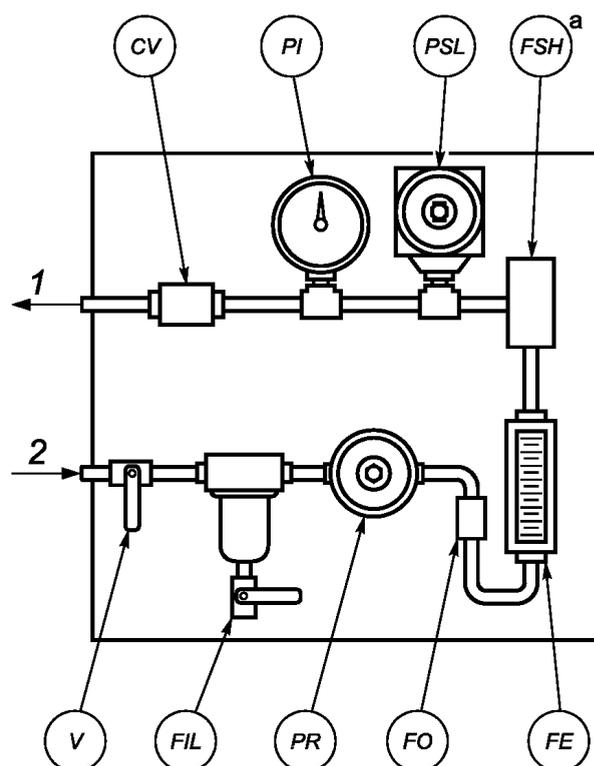
1 — к уплотнению; 2 — от подачи газа; CV — обратный клапан; FE — расходомер; FIL — коалесцирующий фильтр; FO — выпускное отверстие потока 1,5 мм (0,062 дюйма), если необходимо; FSH — верхнее положение выключателя потока; PI — манометр; PR — регулятор давления; PSL — нижнее положение мембранного переключателя; V — отсечной клапан
