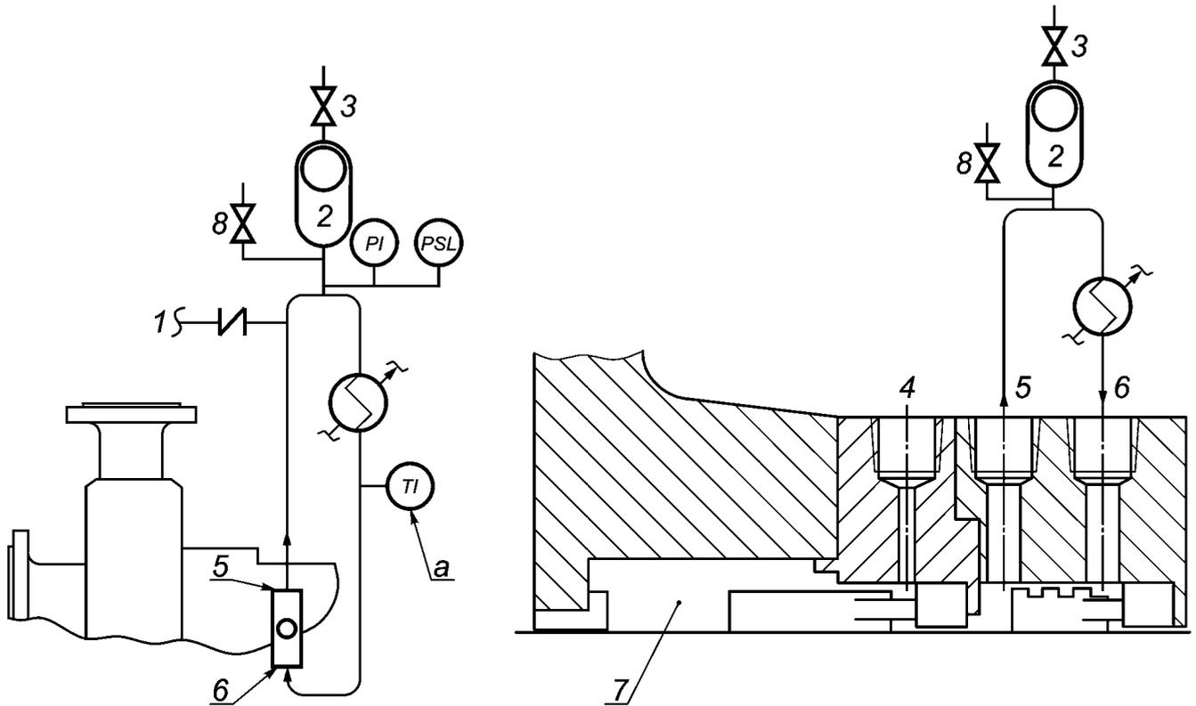
1 — пополнение затворной жидкости; 2 — аккумулятор баллона; 3 — присоединение зарядки баллона; 4 — промывочная жидкость (F); 5 — вывод затворной жидкости (LBO); 6 — ввод затворной жидкости (LBI); 7 — камера уплотнения; 8 — вентиляция; *TI* — манометр; *PSL* — нижнее положение мембранного переключателя; *TI* — указатель температуры
