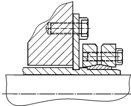
Рисунок 19 — Крепление втулки уплотнения обжимным диском
