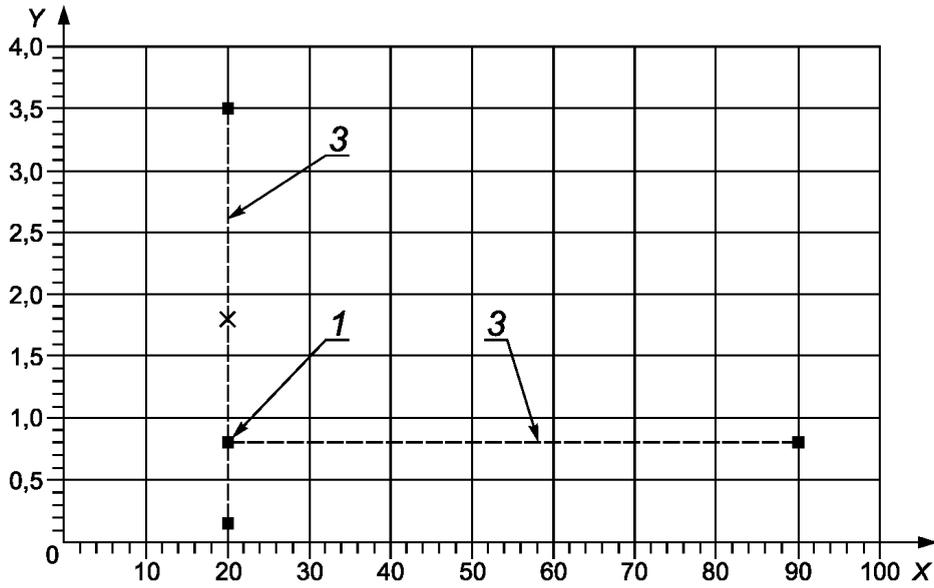
X — температура (°C); Y — абсолютное давление (МПа); 1 — условия базисной точки; 2 — цикл температуры; 3 — цикл давления
