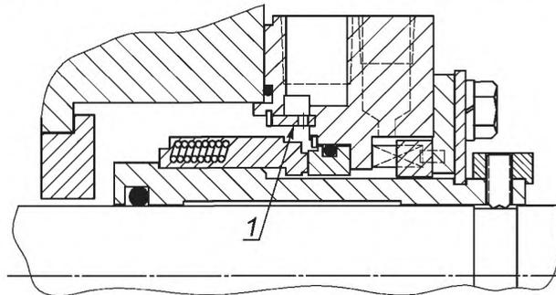
1 — распределитель промывочной жидкости
