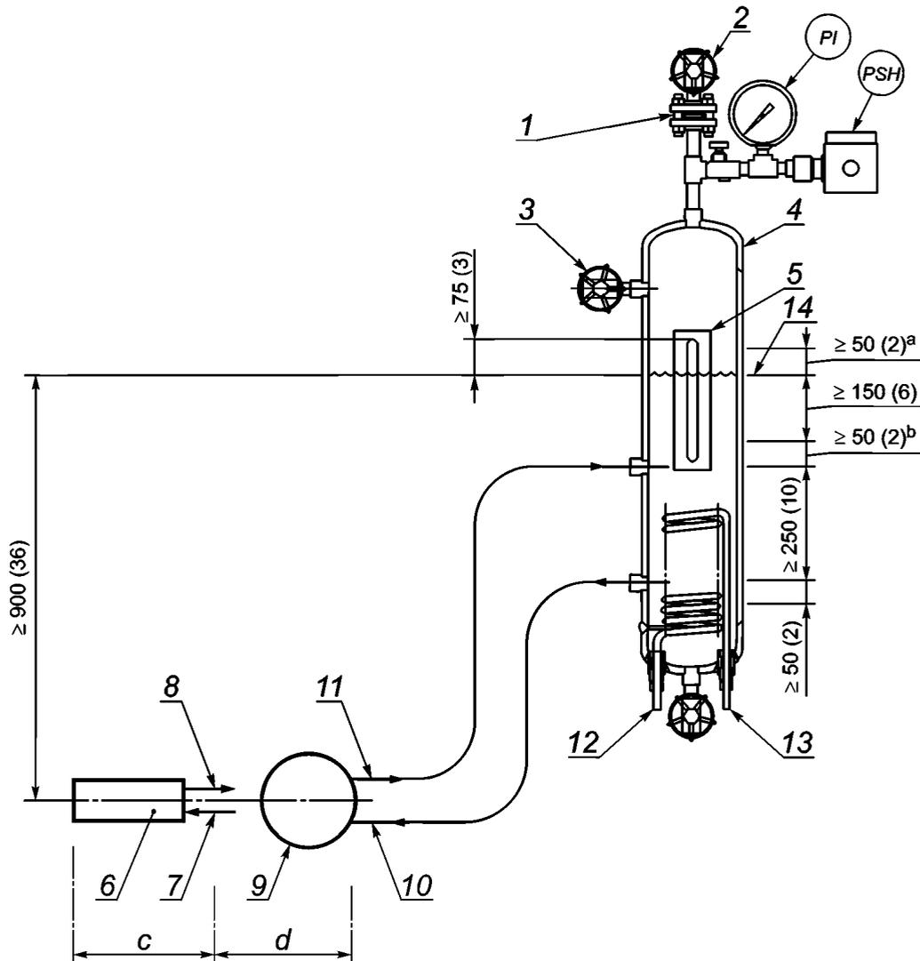
1 — фланцевое выпускное отверстие; 2 — вентиляция; 3 — заполнение резервуара; 4 — резервуар; 5 — поток; 6 — уплотнительная прокладка; 7 — вход к уплотнению; PI — манометр; 8 — вывод среды из уплотнения; 9 — уплотнительная прокладка; 10 — подача к уплотнению; 11 — возврат от уплотнения; 12 — ввод охлаждающей жидкости; 13 — вывод охлаждающей жидкости; 14 — нормальный уровень жидкости; PSH — верхнее положение мембранного переключателя
