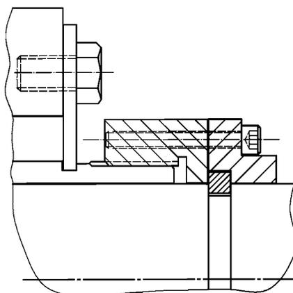
Рисунок 20 — Крепление втулки уплотнения разрезным кольцом
