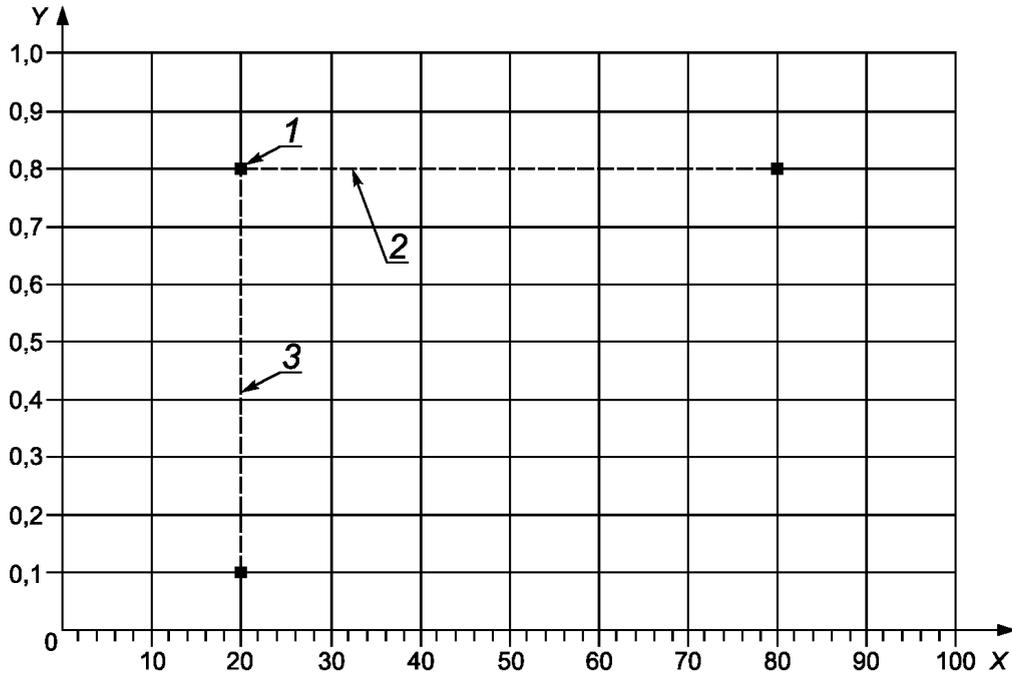
X — температура (°C); Y — абсолютное давление (МПа); 1 — условия базисной точки; 2 — цикл температуры; 3 — цикл давления
