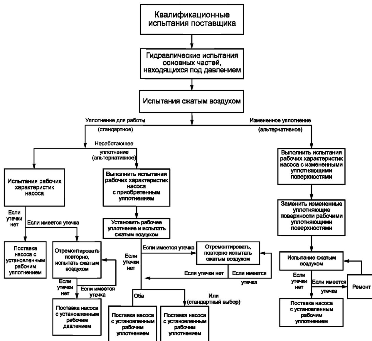
Рисунок 27 — Последовательность действий при проведении испытаний
