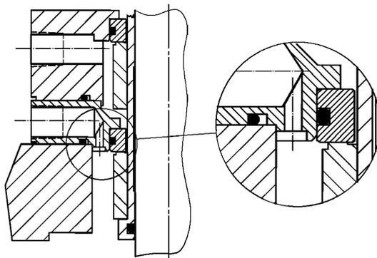
Рисунок 17 — Камера уплотнения/фланец корпуса уплотнения вертикальных насосов
