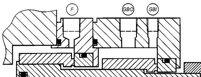
в) конфигурация «сдвоенное уплотнение с подачей буферной жидкости без давления (тандем)», 3NC-FB,
