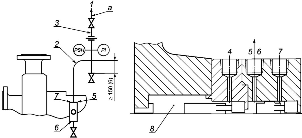
а) Трубопровод и схема измерительного прибора    б) Детали камеры уплотнения
