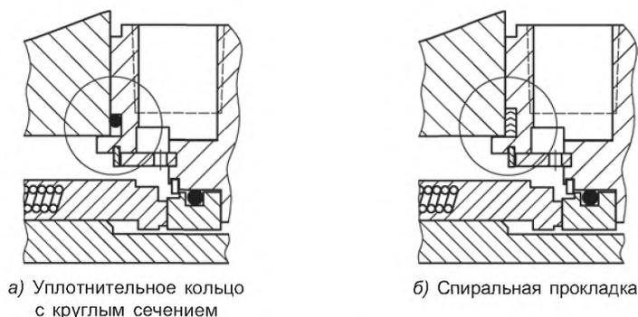
Рисунок 23 — Сопряженные соединения уплотнений
