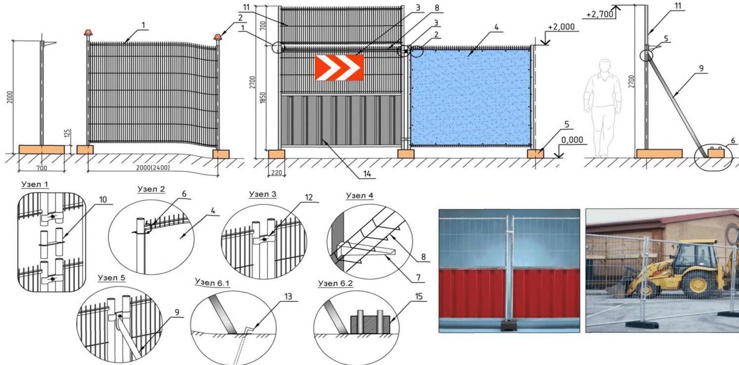
Узел 1 - соединение доборных панелей; Узел 2 - крепление ПВХ экрана к панели ограждения; Узел 3 - соединение секций ограждения;
