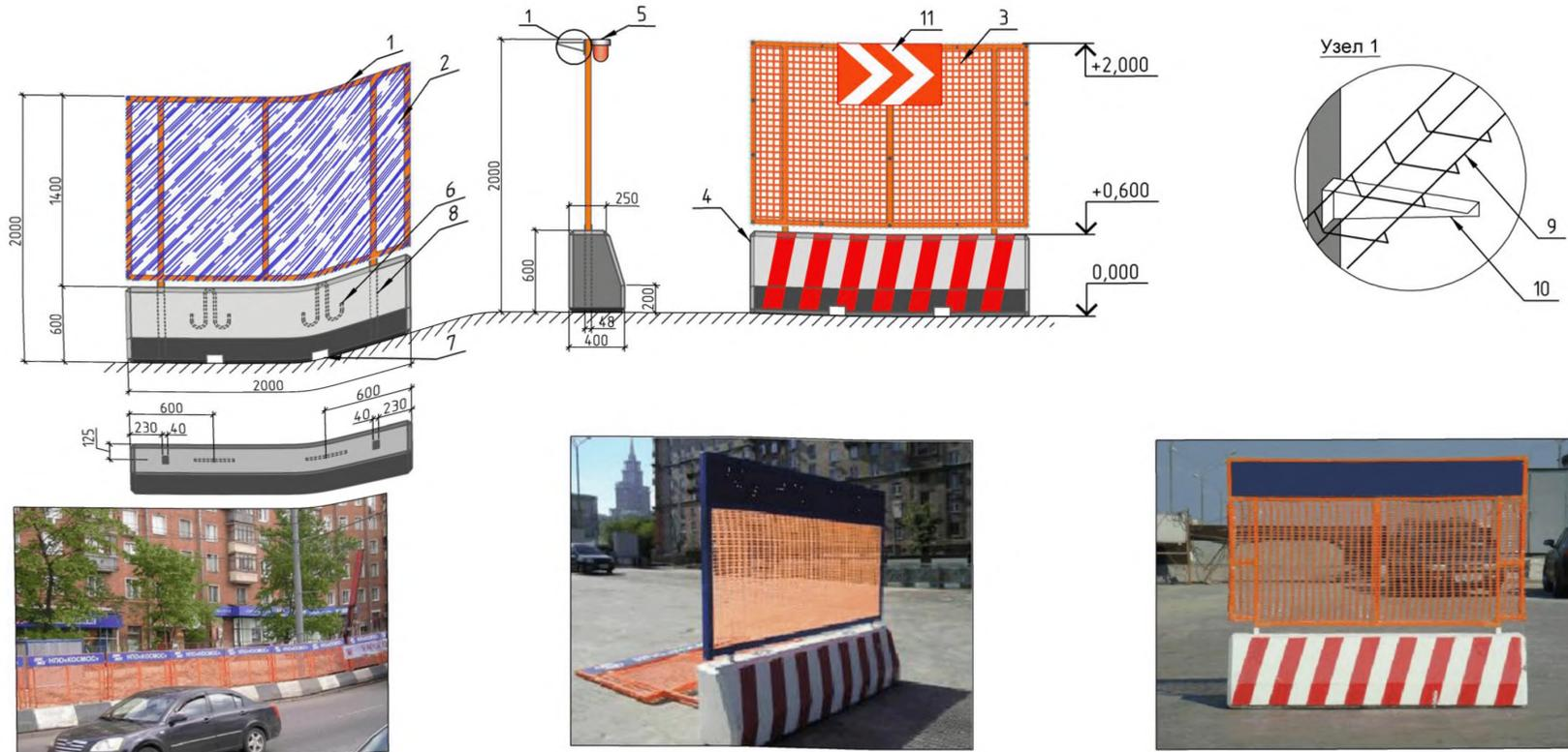
Узел 1 - установка проволочного лотка на стойку ограждения
