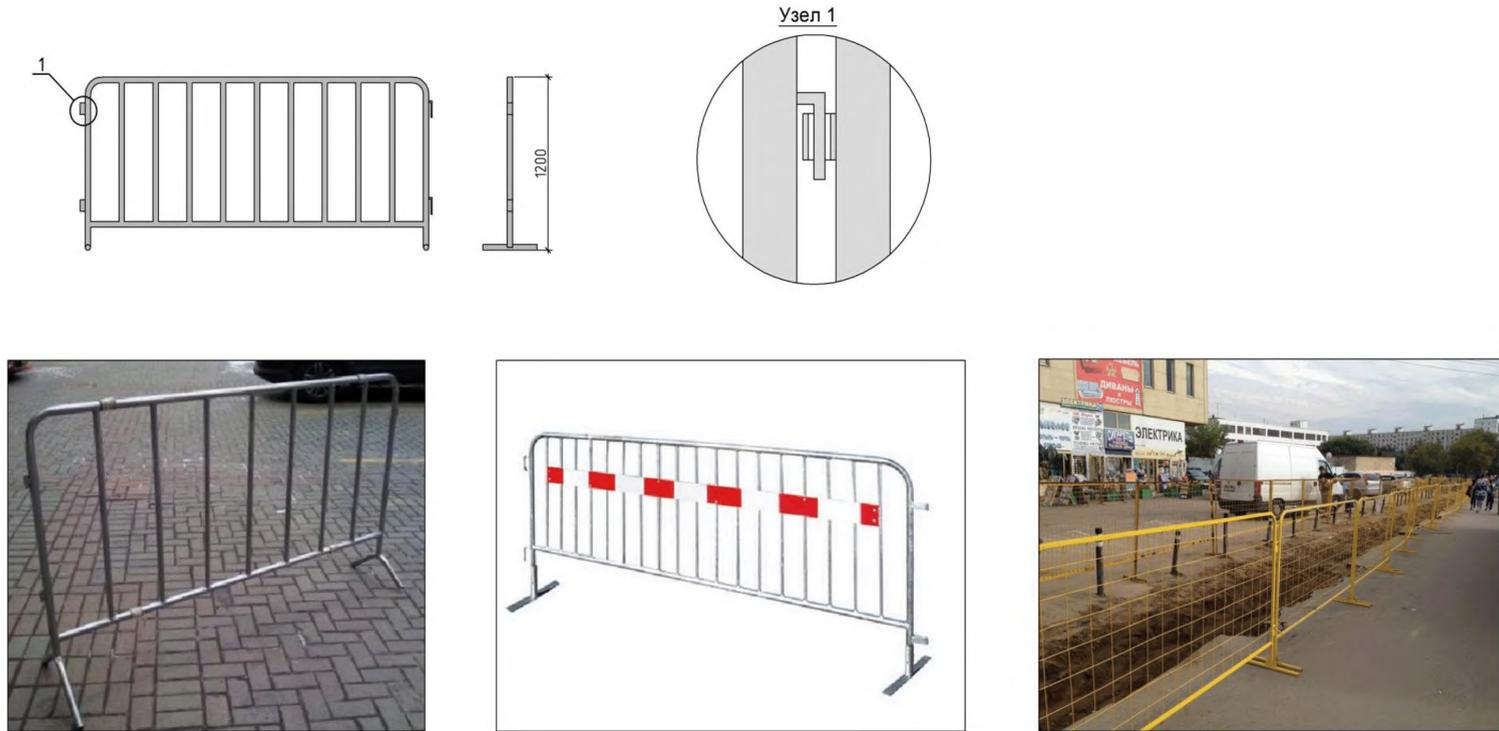
Узел 1- соединение секций ограждения
