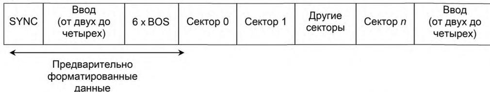
Рисунок 5 — Структура полной дорожки, секторы типов 0—5
