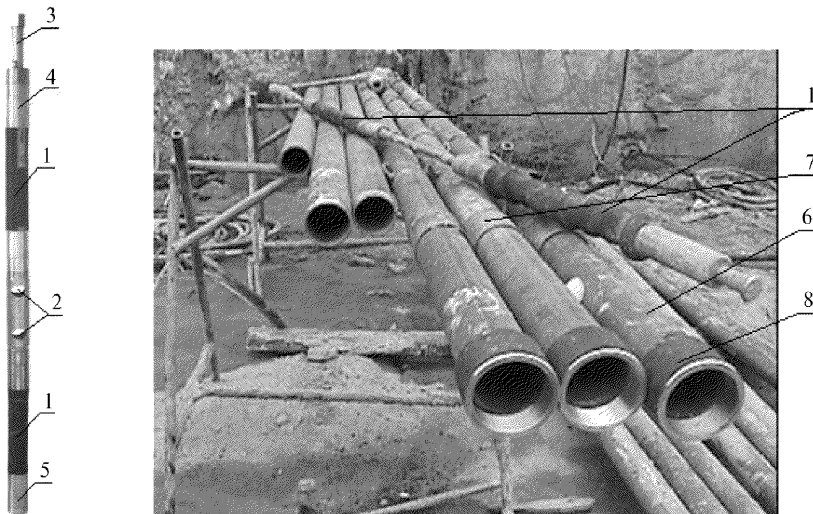
Рисунок 10.10 – Иньектор с двойным уплотнительным тампоном*
