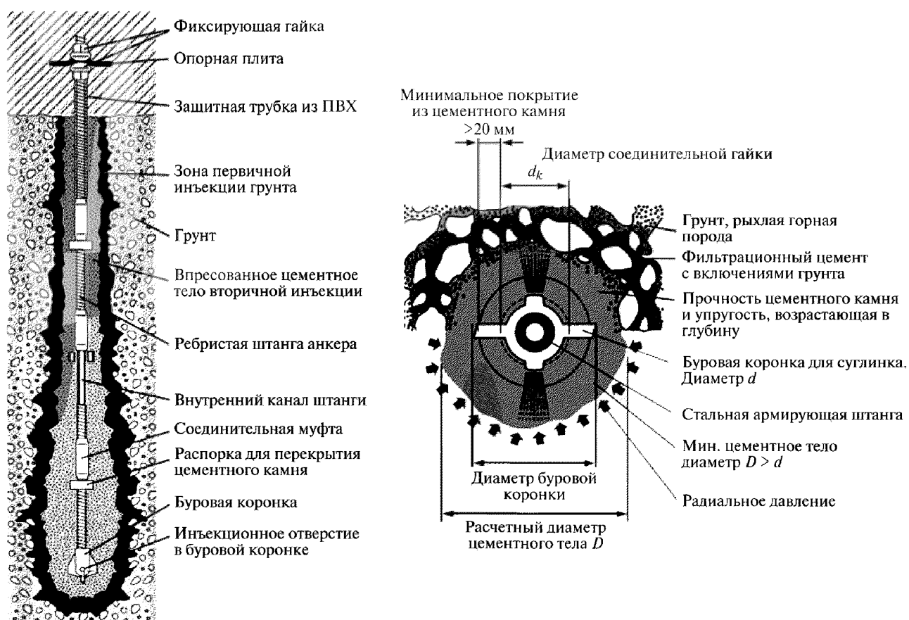
Рисунок 7.15 – Схема закрепления микросваи из ТВШ в грунте*
