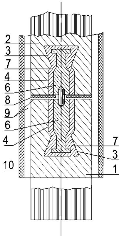
1, 2 – железокремнистые электроды; 3, 4 – глухие отверстия; 5 – стальная шпилька;
