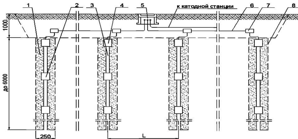
1 – коксовая мелочь; 2 – изоляционное соединение встык; 3 – железо-кремнистый электрод;
