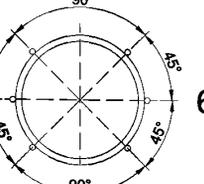
6 | На поверхности теплоизоляционной конструкции трубопровода без защитного покрытия |
