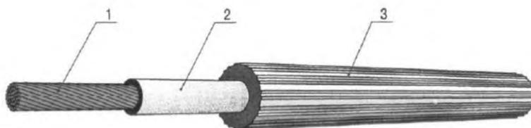
1 – медный или стальной токопровод; 2 – токозадающая оболочка из электропроводного эластомера с удельным объемным электросопротивлением в диапазоне 0,5 – 3000 Ом·м;
