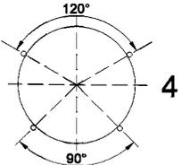
4   | На поверхности трубопровода с защитным диэлектрическим покрытием                 |
