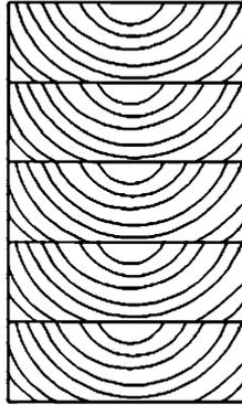
Рисунок 8 – Расположение годовых колец в ламелях при склеивании
