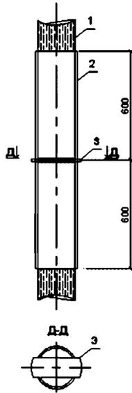
1 – секция наращивания сваи; 2 – стальная труба; 3 – диафрагма
