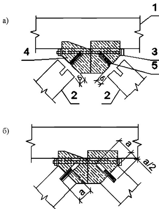
а) положение конструкций непосредственно перед монтажом; верхний пояс опирается на верхний ярус подмостей; б) смонтированный узел
