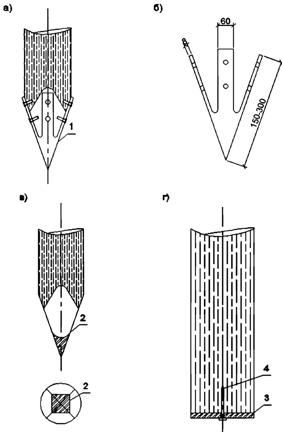
а) сварным башмаком; б) эскиз сварного башмака (размеры в мм); в) кованым башмаком;
