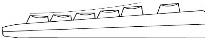
Рисунок 4 – Пример клавиатуры с вогнутым профилем
