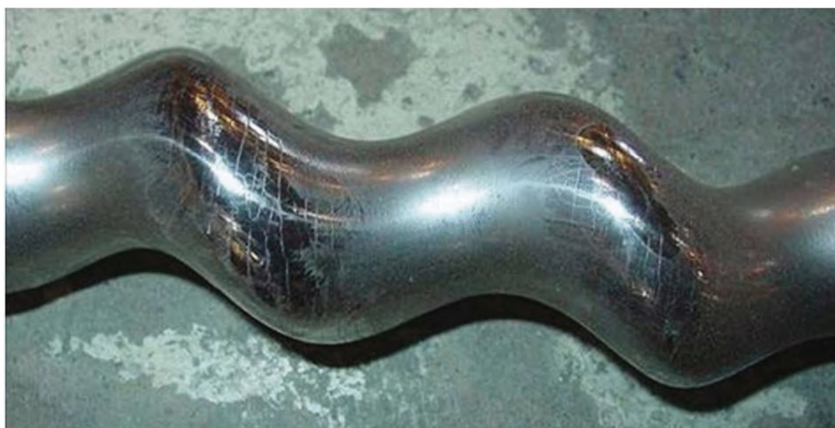
Рисунок 1.3 — Растрескивание/ термическое растрескивание
