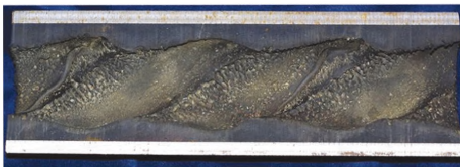
Рисунок I.10 — Рванный /разбитый статор
