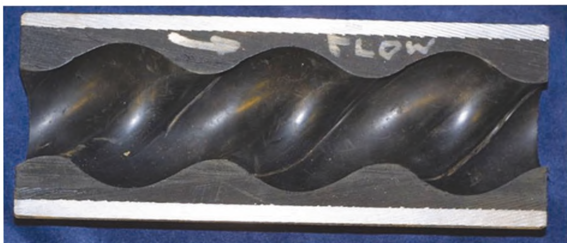
Рисунок 1.7 — Эродированный/ вымытый в результате интенсивной эксплуатации
