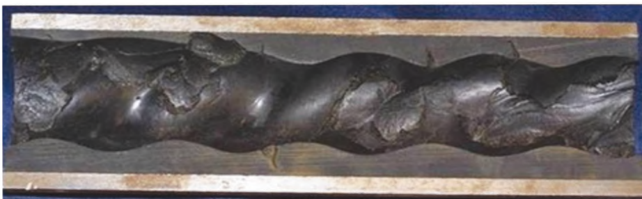
Рисунок I.10 — Рванный /разбитый статор
