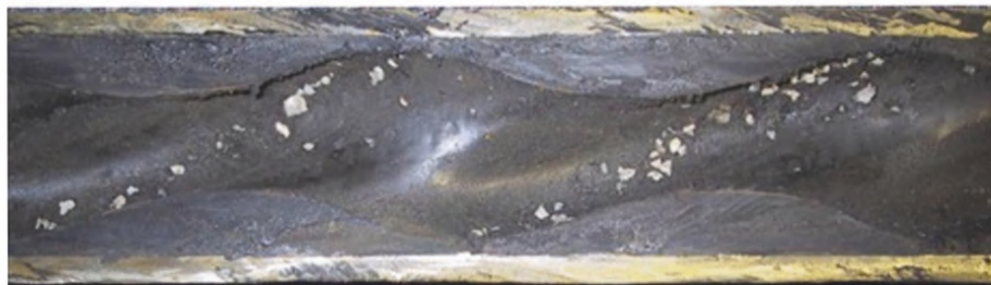
Рисунок I.11 — Загрязнение/инородные частицы в статоре
