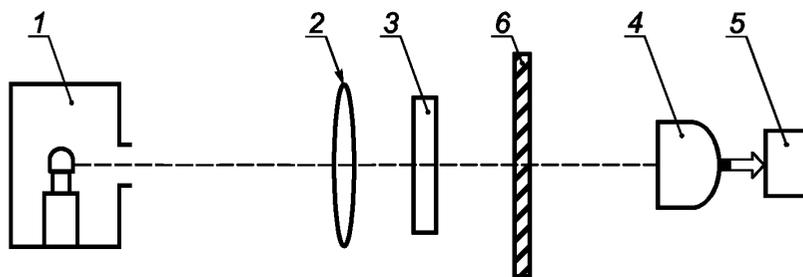
1 — источник света; 2 — оптическая система; 3 — диафрагма; 4 — приемник излучения; 5 — измерительный прибор;
