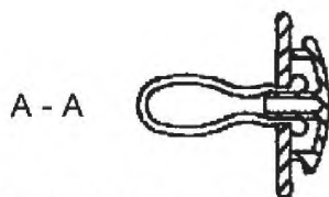
1 – баллончик; 2 – защитный диск; 4 – пробка; 6 – головка Рисунок 2 – Соска с головкой
