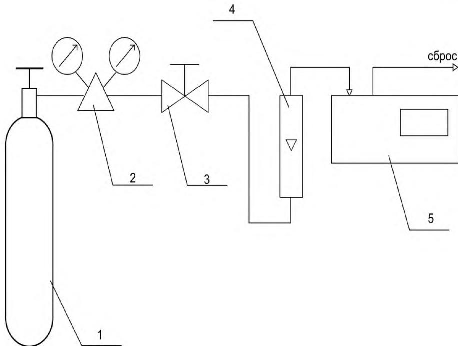
1 – баллон с ГС; 2 – редуктор баллонный; 3 – вентиль точной регулировки; 4 – ротаметр; 5 – монитор
