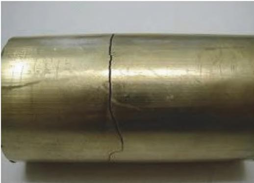
Трещина поперечная на полуфабрикате
