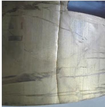
Трещина продольная на слитке
