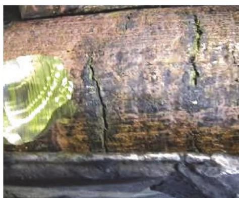
Трещина поперечная на слитке
