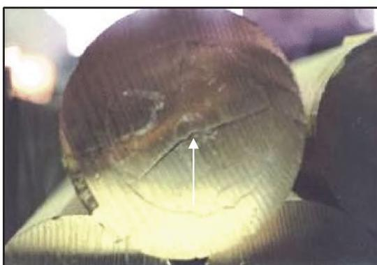
Трещина центровая на слитке
