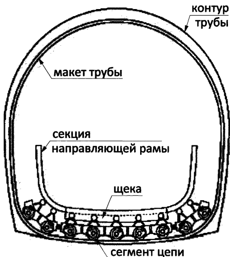
Рисунок 7 – Первый этап сборки навивочной машины
