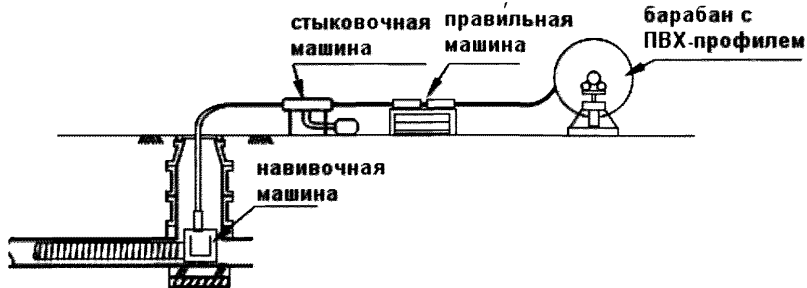
Рисунок К.1 – Размещение оборудования при сварке ПВХ-профиля
