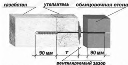
Рисунок Е.4 – Схема установки гибкой связи для газобетона
