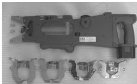
Рисунок 6.4 – Общий вид автоматического пистолета для вязки арматуры
