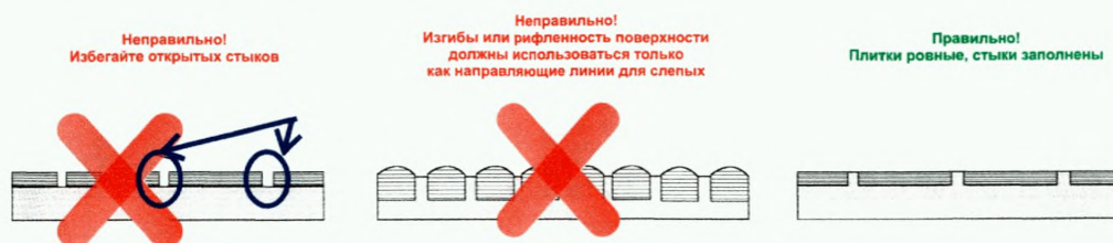
Рисунок 5.9 – Неверная и правильная структуры поверхности элементов обустройства дорог, предназначенных для движения по ним инвалидов и других маломобильных групп населения
