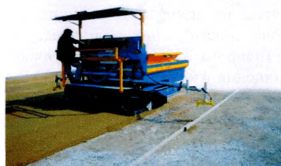
Планировщик для устройства монтажного (выравнивающего) слоя
