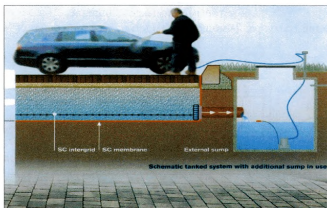
Рисунок 5.33 – Схема работы дренного покрытия
