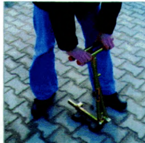
Захват для выемки камня
