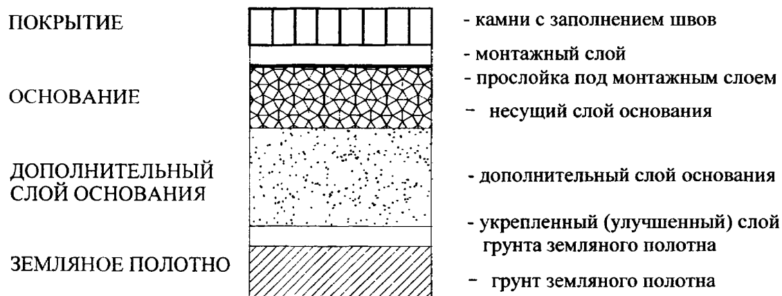
Рисунок 6.1 – Принципиальная схема дорожной одежды
