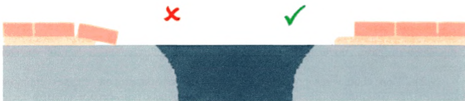
Рисунок 9.1 — Неправильный и правильный варианты ремонта покрытия
