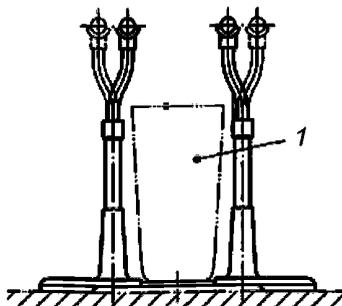
1 — испытательный шаблон в пространстве между жердями брусьев
