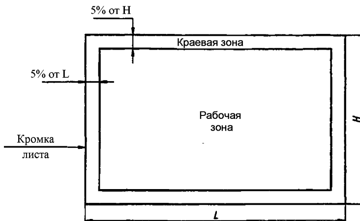
Рисунок 2 – Осматриваемые зоны стекла с покрытием конечного размера
