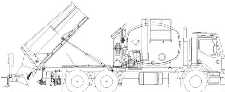
Рисунок В.3б – Гудронатор-распределитель щебня (функционирующий при движении назад с задней рабочей платформой)
