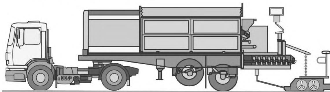
Рисунок В.5 – Машина для нанесения жидкого раствора
