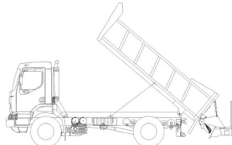
Рисунок В.2 – Распределитель щебня (распределитель)
