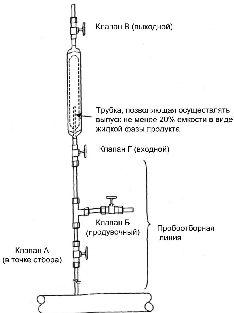
Рисунок 18 — Схема альтернативной продувки пробоотборного контейнера
