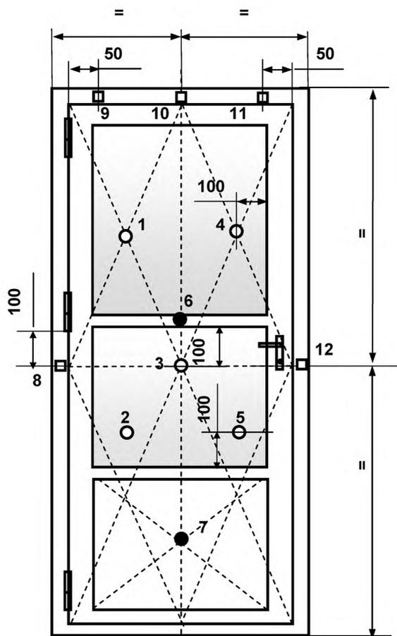
○, ●, □ — места установки термодатчиков
