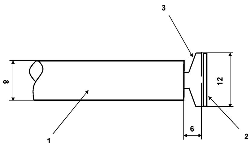
1 — двухканальная керамическая трубка; 2 — медный диск толщиной 0,5 мм;
