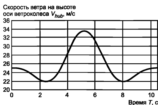
Рисунок 2 — Пример экстремального рабочего порыва
