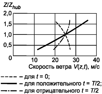
Профиль ветра до начала сдвига ( t = 0 , штриховая линия) и при наибольшем сдвиге ( t = 6 с, сплошная линия)
