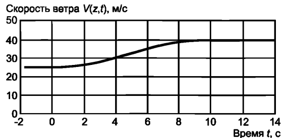
Рисунок 5 — Пример экстремального когерентного порыва с изменением амплитуды порыва для ЭКН
