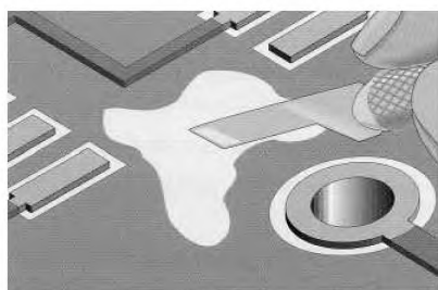
Рисунок 9 а – Удаление поврежденного материала
