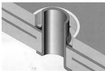
Рисунок 41 b – Подпайка втулки пистона к вскрытому внутреннему слою
