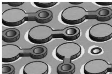
Рисунок 44 а – Фрезерование в плате сквозных отверстий и установка тефлоновой трубки
