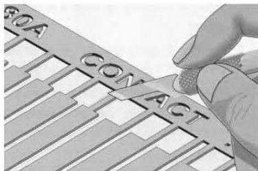
Рисунок 35 с – Вырезание нового концевого контакта
