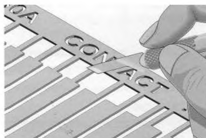
Рисунок 34 б – Вырезание нового концевого контакта
