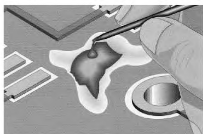
Рисунок 9 с – Нанесение эпоксидного клея деревянной палочкой
