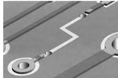
Рисунок 22 b – Сверление сквозных отверстий рядом с проводником
