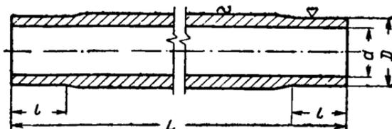
1.3. Наружная поверхность концов труб должна быть обточена на длину  $l=200 \text{ мм}$  с плавным переходом к необточенной части.
