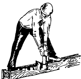
Рис. 39. Устройство проушины в новом брус
