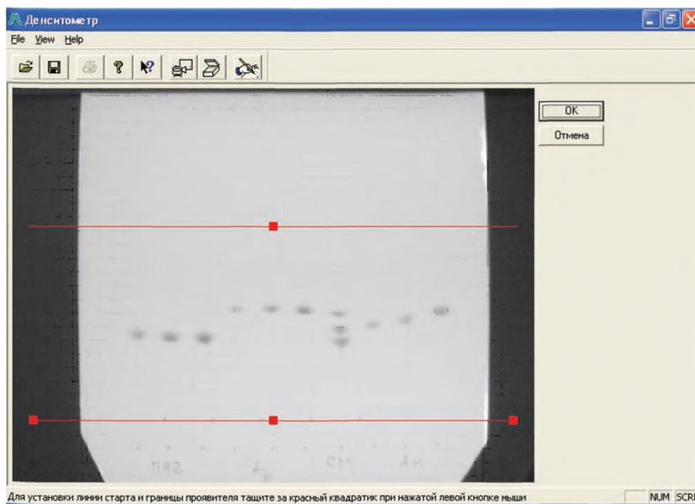
Рисунок В.1 — Указание линий старта и границы элюента
