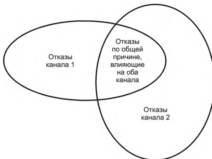
Рисунок D.1 — Связь между отказами по общей причине и отказами отдельных каналов
