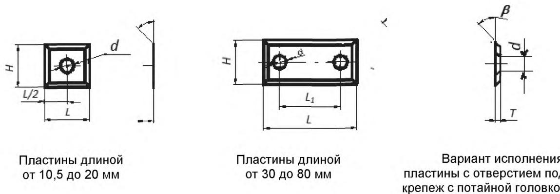
Рисунок 2 — Тип 1, исполнение 2
