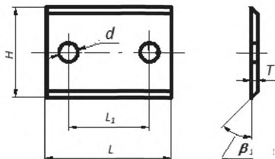
Рисунок 6 — Тип 3, исполнение 2
