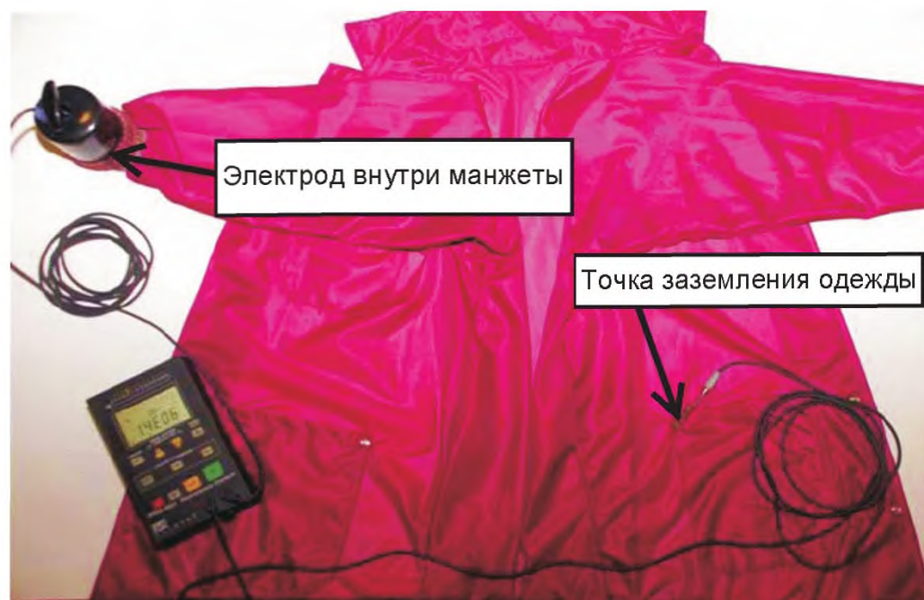
Рисунок 8 — Испытательная сборка — сопротивление «от точки до точки заземления» (процедура «манжета — точка заземления» с использованием изолирующих вкладок)
