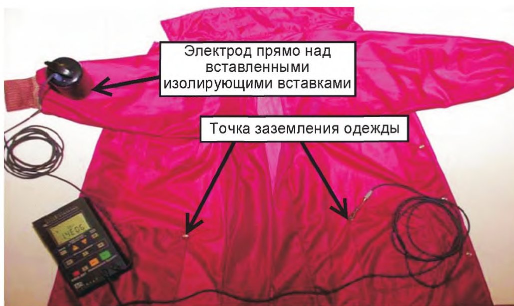
Рисунок 9 — Испытательная сборка — сопротивление «от точки до точки заземления» (процедура «рукав — точка заземления» с использованием изолирующих вкладок)
