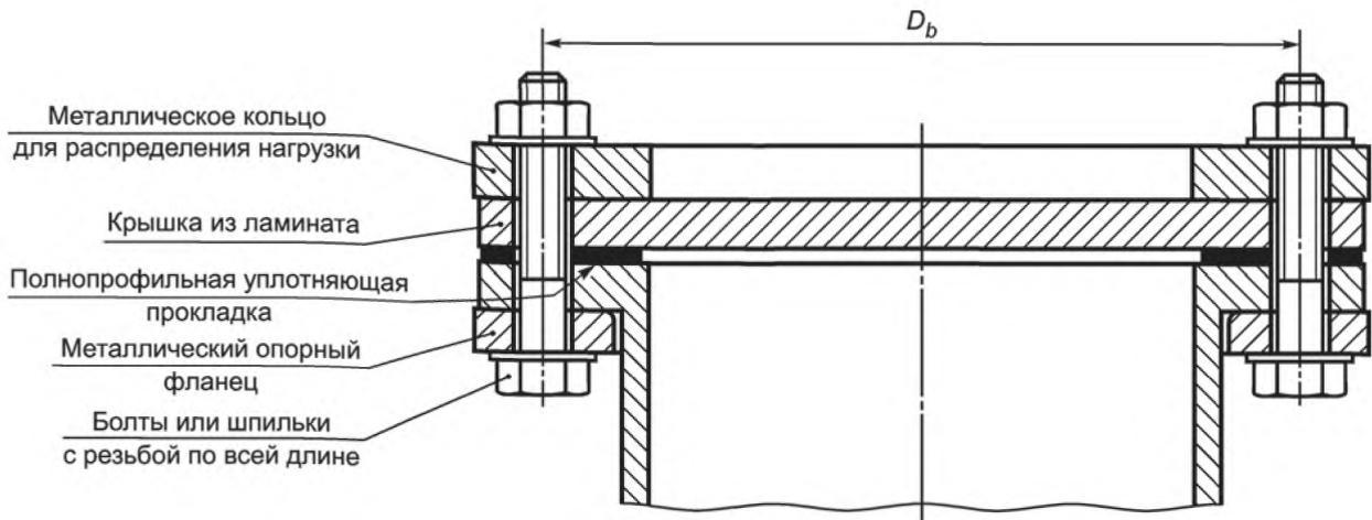
$D_b$  — диаметр окружности центров отверстий зажимных болтов
