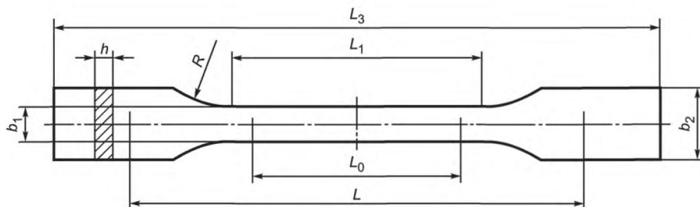
$L_3$  — общая длина;  $L_1$  — длина узкой параллельной части;  $R$  — радиус закругления;  $b_2$  — ширина на концах;  $b_1$  — ширина узкой части;  $h$  — толщина;  $L$  — исходное расстояние между захватами;  $L_0$  — измерительная база
