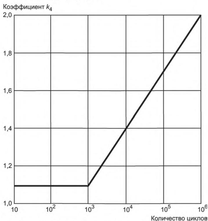
Рисунок А.2 — Коэффициент, соответствующий циклическим нагрузкам
