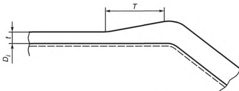
$T$  — длина плавного перехода;  $t$  — толщина ламината;  $D_i$  — внутренний диаметр корпуса
