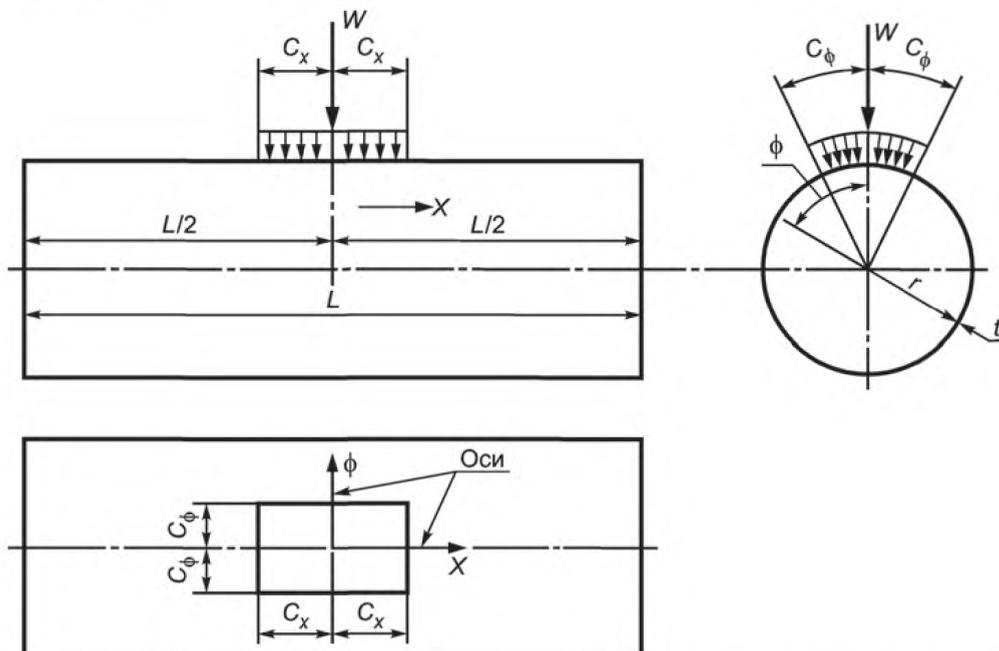
$C_x$  — половина длины прямоугольной области, подвергающейся нагрузке, в продольном направлении;  $L$  — длина цилиндрической части корпуса;  $W$  — внешняя нагрузка, распределенная по области, подвергающейся нагрузке;  $\phi$  — цилиндрические координаты точки в стенке напорной емкости
