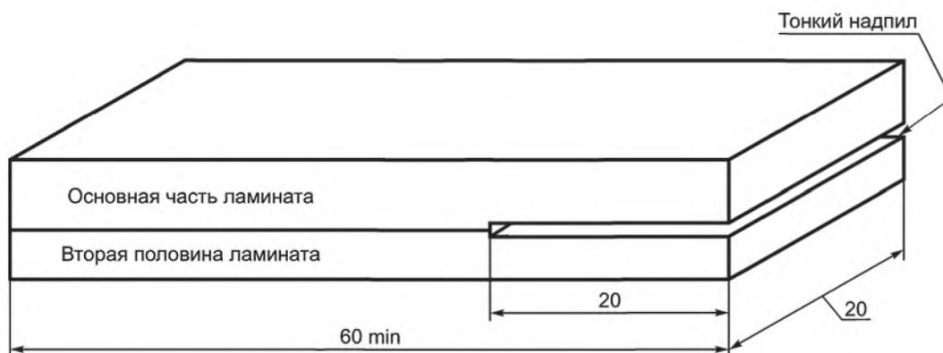
Рисунок Ш.1 — Образец для определения предела прочности на раздир связи между слоями ламината
