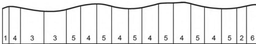
Рисунок Б.4 — Конструкция ламината толщиной 15,8 мм
