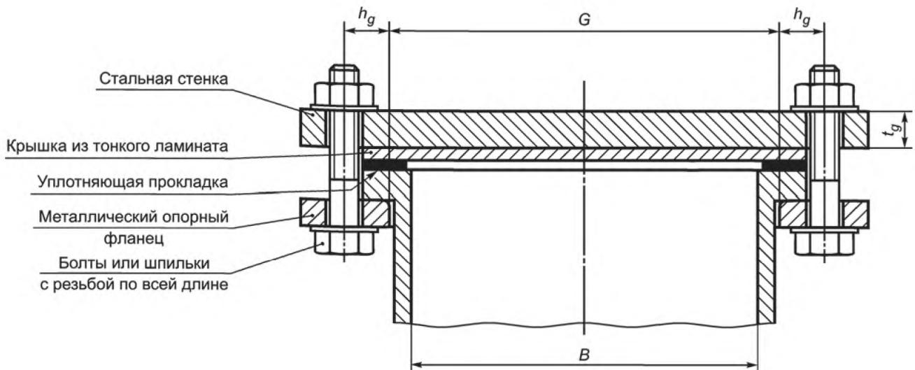
$G$  — диаметр области реакции уплотняющей прокладки на нагрузку;  $h_g$  — расстояние по радиусу от области реакции уплотняющей прокладки на нагрузку до болтового отверстия;  $B$  — внутренний диаметр фланца
