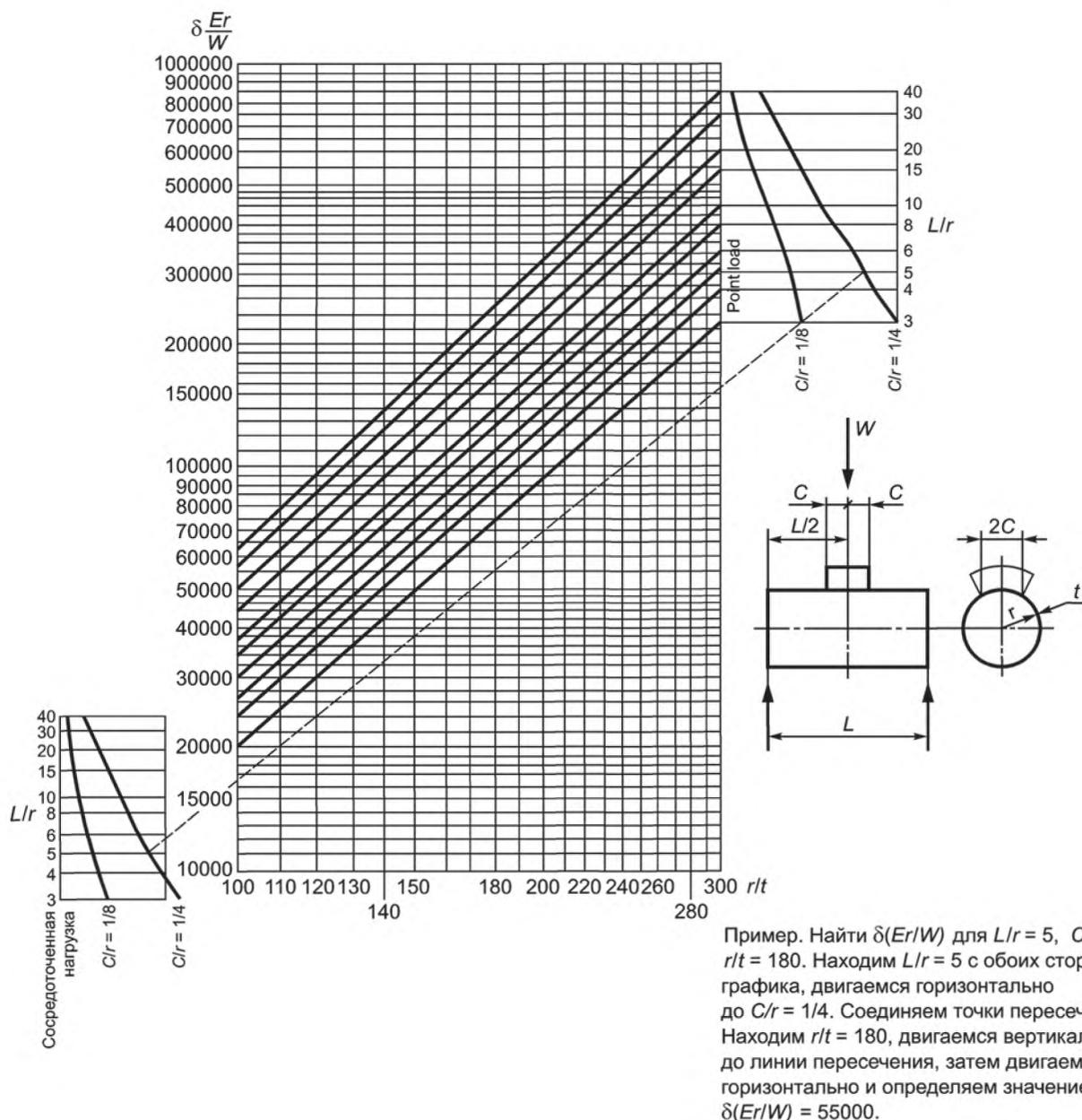
Рисунок У.20 — Максимальная радиальная деформация цилиндрического корпуса, на который действует радиальная нагрузка  $W$ , равномерно распределенная по квадрату  $2C \cdot 2C$
