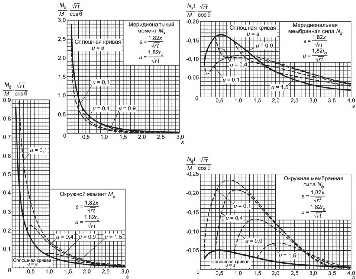
Рисунок У.30 — Моменты и мембранные силы в корпусе сферической формы при воздействии на него внешнего момента  $M$
