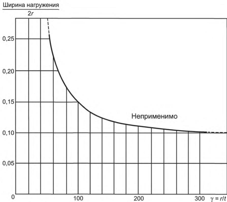
$C_\phi$  — половина длины прямоугольной области, подвергающейся нагрузке, в направлении вдоль окружности;  $r$  — среднее значение радиуса цилиндра или сферы;  $t$  — толщина стенки корпуса
