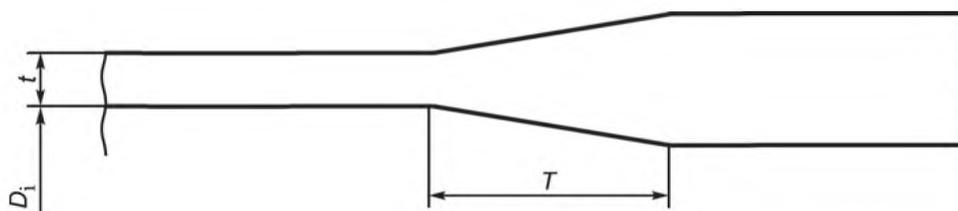
$T$  — длина плавного перехода;  $t$  — толщина ламината;  $D_i$  — внутренний диаметр корпуса
