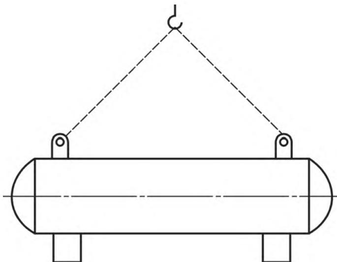
Рисунок X.5 — Проушины в плоскости горизонтальной напорной емкости
