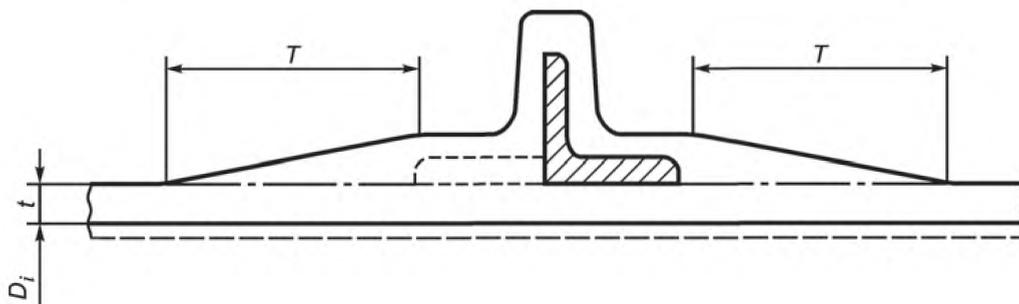
$T$  — длина плавного перехода;  $t$  — толщина ламината;  $D_i$  — внутренний диаметр корпуса
