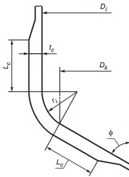
$L_c$  — расстояние от места пересечения конической и цилиндрической частей, на котором должна быть увеличена толщина до значения  $t_c$ ;  $t_c$  — расчетная толщина в месте пересечения конической и цилиндрической частей;  $D_k$  — внутренний диаметр большего основания конического днища;  $\phi$  — угол наклона конического днища к оси напорной емкости
