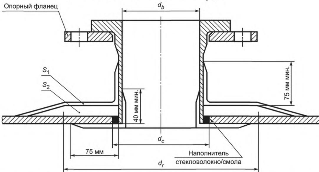
$d_b$  — внутренний диаметр патрубка;  $d_r$  — диаметр армирования компенсации в начале сглаживания;  $S_1$  — внешний перекрывающий слой ламината;  $S_2$  — компенсационные слои ламината
