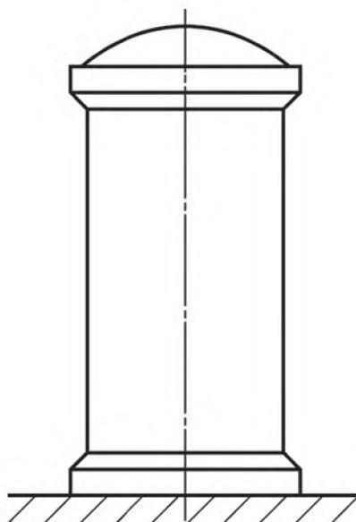
Рисунок 9.6 — Хранение емкости вертикального исполнения в вертикальном положении
