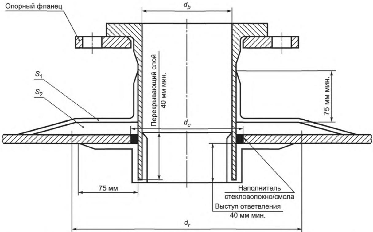
Рисунок К.3 — Схематическое изображение типовых патрубков: установленный с выступом патрубка без термопластичной футеровки (отверстие более 100 мм)
