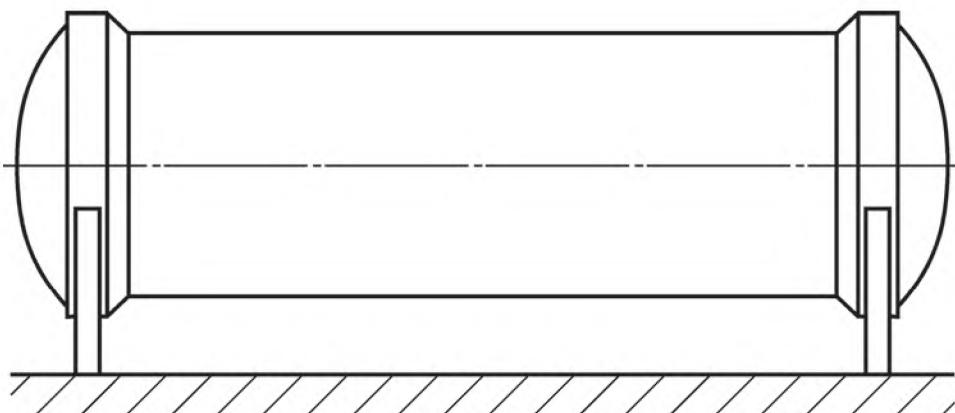
Рисунок 9.4 — Хранение емкости на двух опорах
