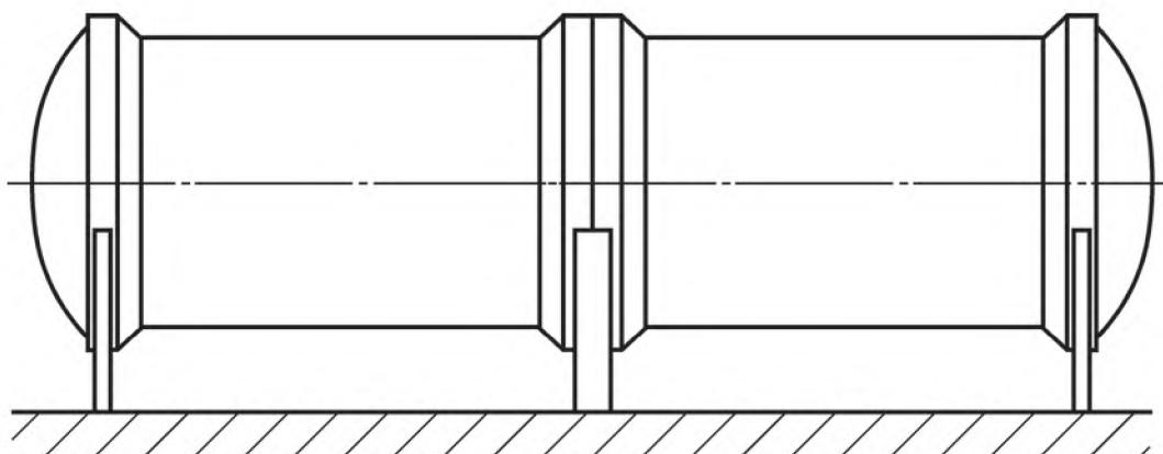
Рисунок 9.5 — Хранение емкости на трех опорах
