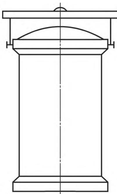
Рисунок 9.3 — Подъем емкости вертикального исполнения за цапфы
