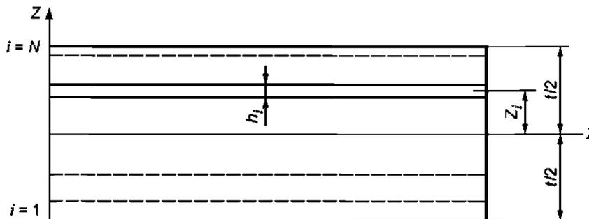
Рисунок П.1 —  $n$  слой балки из ламината
