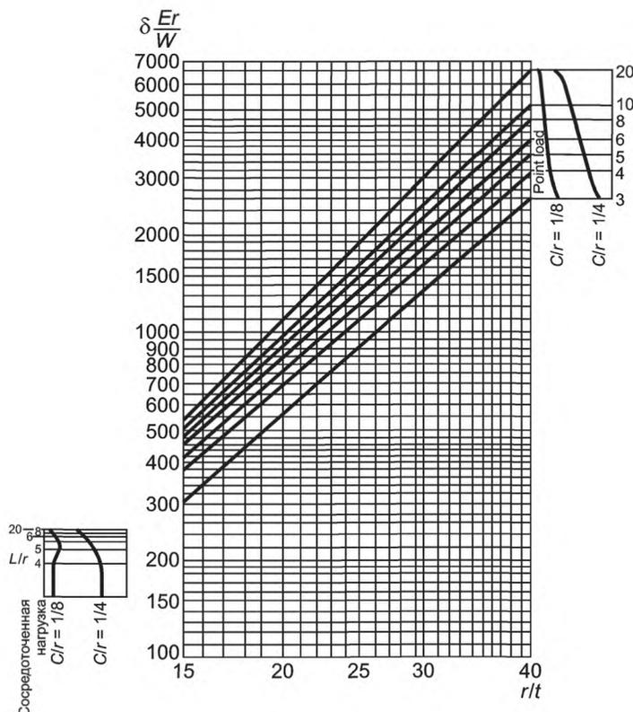
Рисунок У.18 — Максимальная радиальная деформация цилиндрического корпуса, на который воздействует радиальная нагрузка  $W$ , равномерно распределенная по квадрату  $2C \cdot 2C$
