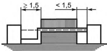
У с л о в и е. В промежутке имеется выступ, представляющий собой не скрепленное клеем соединение с канавкой шириной менее 1,5 мм с одной стороны и с канавкой шириной равной или более 1,5 мм с другой стороны
