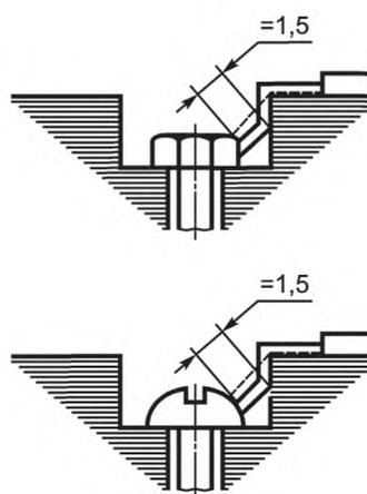
П р а в и л о. Зазор между головкой винта и стенкой углубления слишком узкий, чтобы его учитывать. Измерение пути утечки по поверхности следует начинать от точки на стенке углубления, отстоящей от винта на расстоянии 1,5 мм
