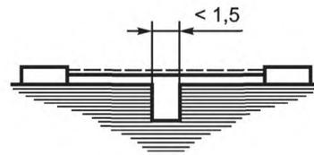
Условие. В промежутке имеется канавка с параллельными сторонами любой глубины  $d$ , шириной, равной или более 1,5 мм
