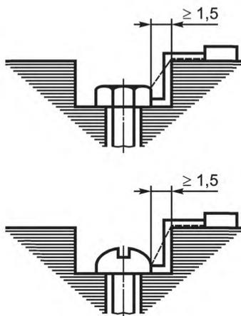
П р а в и л о. Зазор между головкой винта и стенкой углубления достаточно широкий, поэтому его следует учитывать
