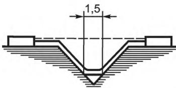
Условие. В промежутке имеется V-образная канавка шириной более 1,5 мм
