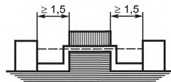
Условие. В промежутке имеется выступ, представляющий собой не скрепленное клеем соединение с канавками шириной, равной или более 1,5 мм с каждой стороны
