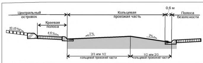
Рис. 7.38 Двухскатный поперечный профиль многополосной кольцевой проезжей части
