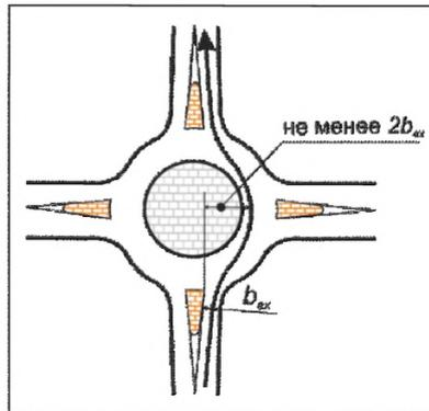
Рис. 7.31 Смещение траектории движения при проезде мини-кольцевого пересечения
