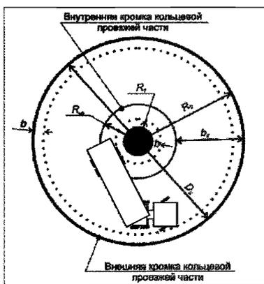
$D_k$  – диаметр кольцевого пересечения,  $R_{цo}$  – радиус центрального островка, -
