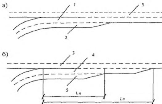
Рис. 9.2, а, б. Схемы планировки участка примыкания двухполосного съезда к главной дороге с устройством дополнительной полосы (а), с двумя переходно-скоростными полосами (б):
