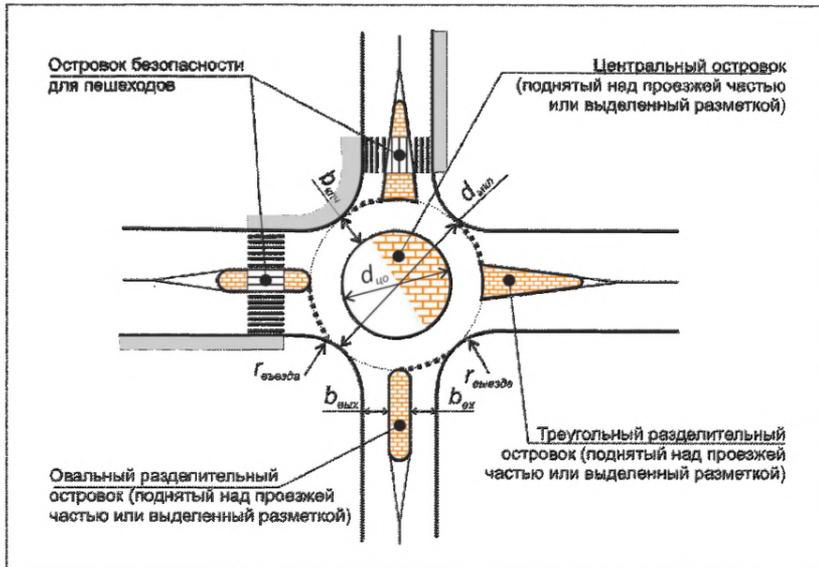
$d_{\text{мкп}}$  – диаметр мини-кольцевого пересечения;  $d_{\text{цo}}$  – диаметр центрального островка;  $b_{\text{кпч}}$  – ширина кольцевой проезжей части;  $b_{\text{въезд}}$  и  $b_{\text{выезд}}$  – ширины проезжей части при въезде и выезде с кольца;  $r_{\text{выезда}}$  и  $r_{\text{въезда}}$  – радиусы кромок проезжей части (бортового камня) при въезде на кольцо и выезде с кольцевой проезжей части;
