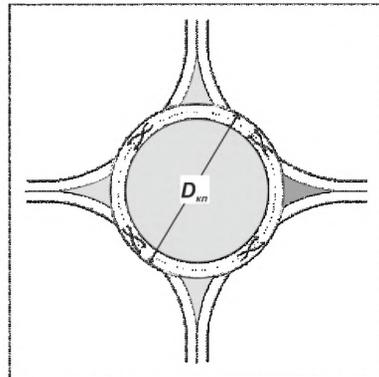
Рис. 7.2 Схемы основных планировочных решений кольцевых пересечений
