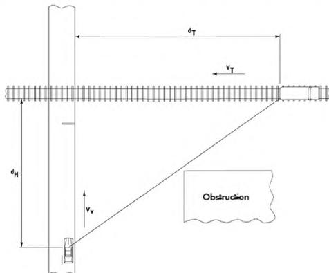
Рис. 15.14 Схема расчета минимального расстояния видимости на пересечении с железной дорогой
