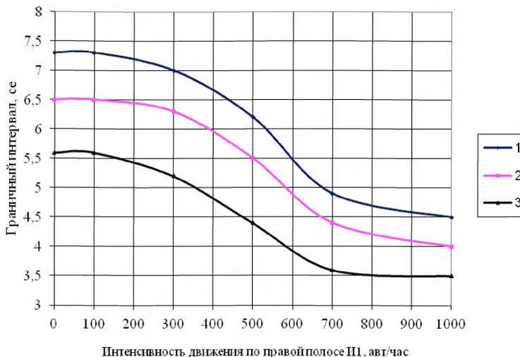
Рис. 1 Зависимость  $\Delta t_{cp}$  от интенсивности движения по правой полосе дороги.
