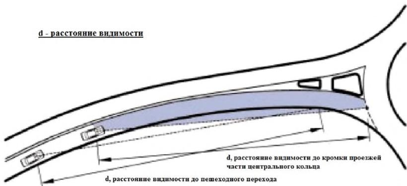
Рис. 15.5 Схема к расчету минимального расстояния видимости при въезде на кольцевое пересечение
