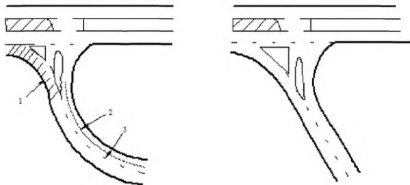
Рис. 6.12 Зрительное перекрытие островками запрещенного направления движения:
