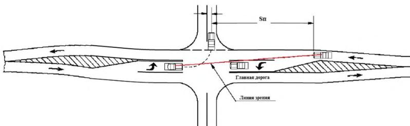
Рис. 15.4 Схема для расчета Минимального расчетного расстояния видимости на левоповоротном съезде с основной дороги
