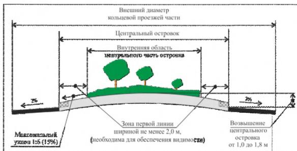
Рис. 7.39 Зонирование кольцевого пересечения при разработке архитектурно-ландшафтного оформления: план (а) и поперечное сечение (б)
