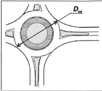
в - кольцевые пересечения большого диаметра ( $D_{кп} = 40 - 60$  м)
