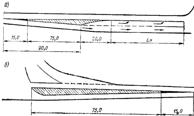
Рис. 6.8, а, б. Разделительные островки на главной дороге:
