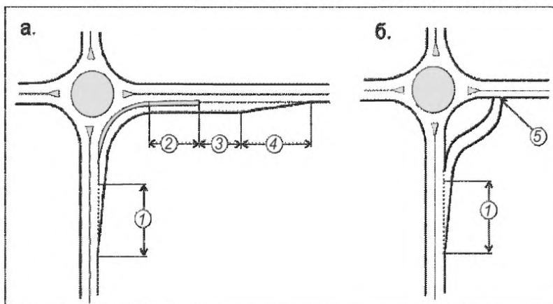
1 – участок отгона ширины полосы торможения; 2 – участок разгона переходно-скоростной полосы; 3 – участок маневрирования; 4 - участок отгона ширины переходно-скоростной полосы разгона; 5 – въезд на проезжую часть без полосы ускорения.
