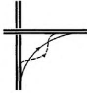
Рис. 8.11 Расположение правоповоротных соединительных рампы между пересекающимися дорогами.
