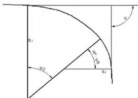
Рис.6.7 Элементы коробовой кривой
