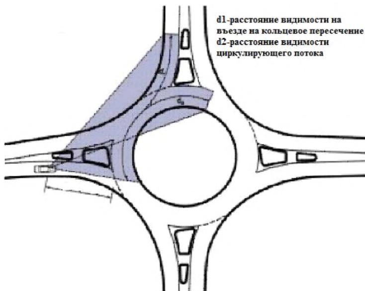
Рис. 15.6 Схема для расчета минимального расстояния видимости на въезде на кольцевое пересечение и участке циркулирующего потока.
