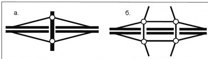
а – «ромб» с двумя кольцевыми пересечениями на второстепенной дороге;
