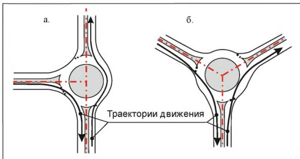
Рис. 7.12 - Траектории движения в пределах кольцевой проезжей части, обеспечивающие движение с пониженными скоростями (а) и допускающие возможность движения с высокой скоростью (б)
