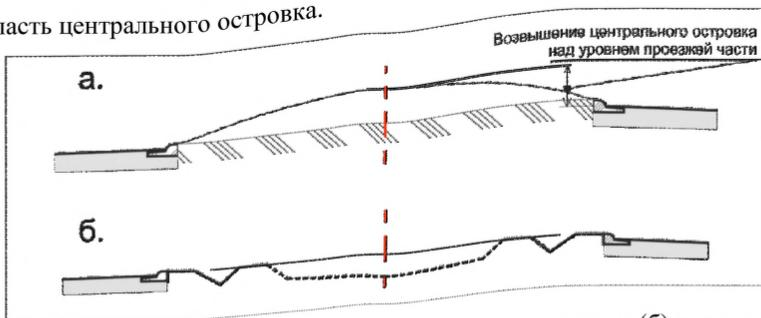
Рис. 7.4 Центральные островки выпуклого (а) и вогнутого (б) очертания
