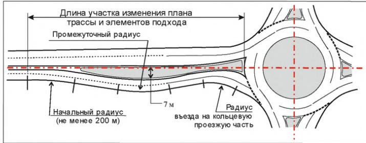
Рис. 7.13 Уширение направляющего островка (центральной разделительной полосы)
