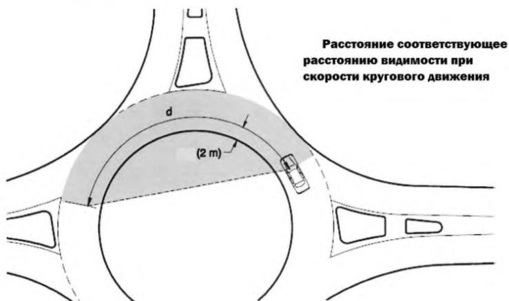
Рис. 15.8. Схема для определения минимального расстояние видимости для остановки на проезжей части кольцевого пересечения
