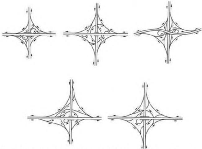
Рис 8.6 Многоуровневые полунаправленные и директивно направленные, полунаправленные, четырехуровневые, компактные.
