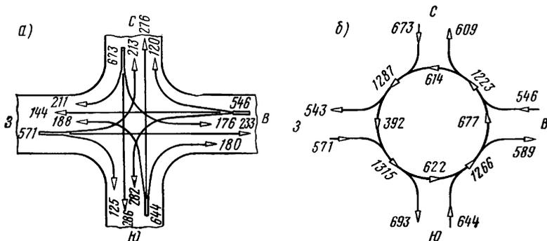
Рис 4.11.1 Картограмма интенсивности движения:
