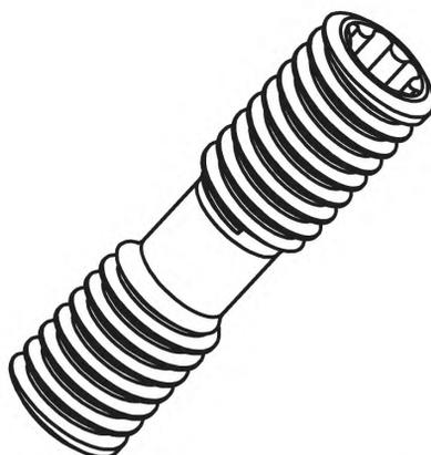
Рисунок Е.4 — Дифференциальный винт
