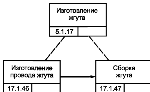
Рисунок В.4 — Процесс изготовления жгута изделия GT-350
