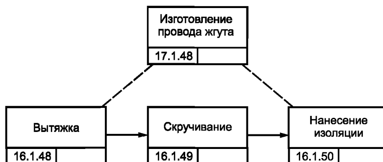
Рисунок В.5 — Процесс изготовления провода жгута
