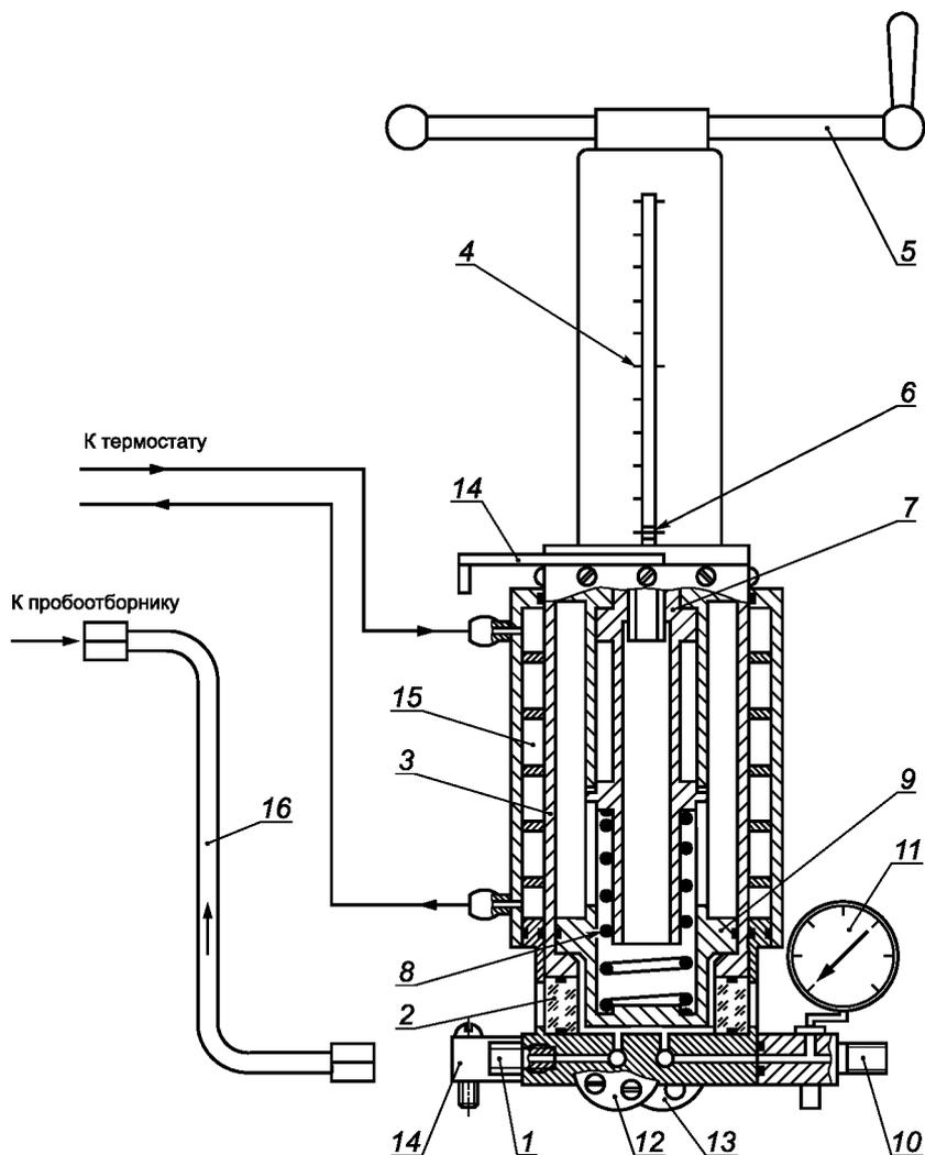
Заборная камера: 1 — входной штуцер; 2 — нижняя часть рабочего цилиндра, выполненного из оргстекла; 3 — верхняя стальная часть цилиндра; 10 — выходной штуцер; 11 — манометр; 12 — входной вентиль; 13 — выходной вентиль; 14 — опора; 15 — термостатирующая рубашка; 16 — шланг высокого давления.
