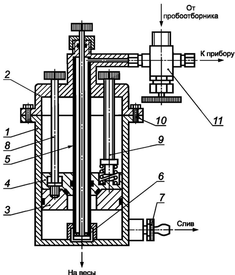
1 — стакан; 2 — крышка; 3 — нижняя часть поршня; 4 — верхняя часть поршня; 5 — подводящая трубка; 6 — входной клапан; 7 — выходной клапан; 8 — стяжные толкатели; 9 — вспомогательные толкатели; 10 — крепежные винты; 11 — вентиль-распределитель
