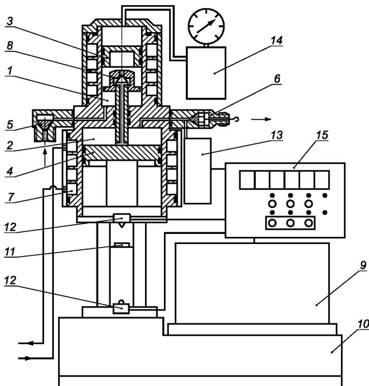
Измерительный блок: 1— пробоотборная камера; 2— измерительная камера; 3, 4— поршень; 5— входной клапан; 6— выходной клапан; 7— термостатирующая рубашка; 8— впрысочный клапан; 13— датчик давления; 14— подпорная газовая камера; 15— блок управления.
