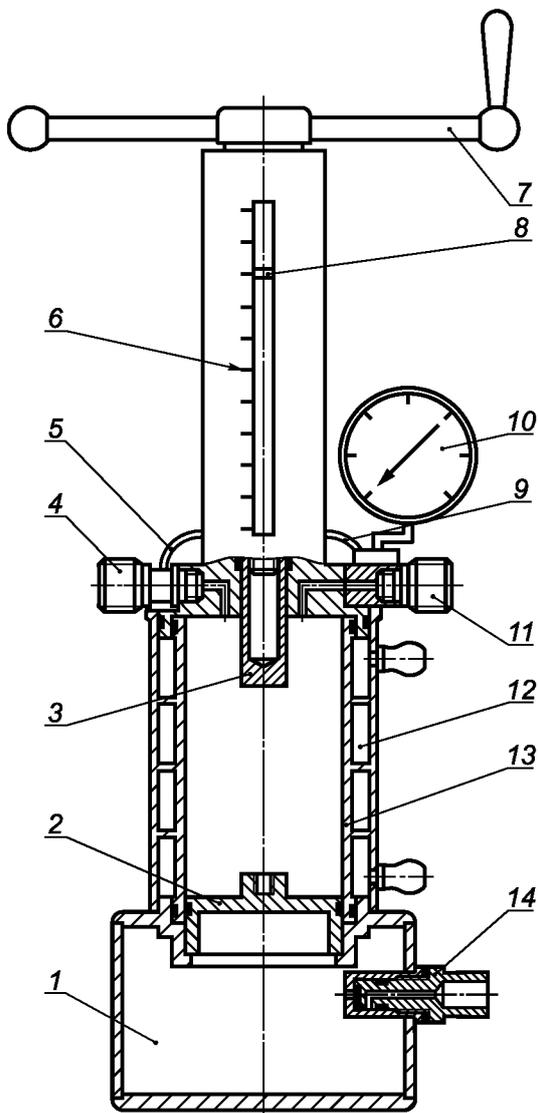
Пробоотборная камера: 2 — поршень; 4 — входной штуцер; 5 — входной вентиль; 9 — выходной вентиль; 10 — манометр; 11 — выходной штуцер; 12 — термостатирующая рубашка; 13 — цилиндр.
