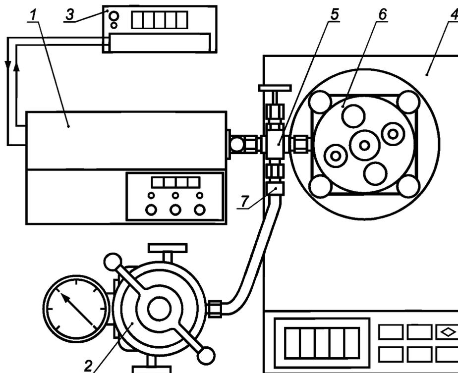
1 — прибор АЛП-01 ДП-01; 2 — индивидуальный пробоотборник; 3 — термостат; 4 — весы лабораторные;
