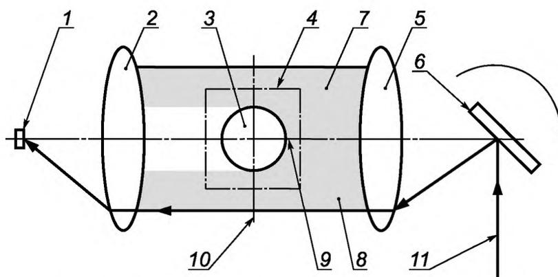
Примечание — У одноосного сканирующего устройства зона измерения расположена в идеальном месте на пересечении линии измерения и центральной линии сканирования. При расположении испытуемого образца в зоне измерения достигается большая точность измерения.
