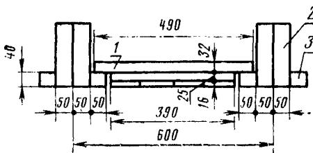
1—щит перекрытия; 2—балка перекрытия; 3—черепной бруск.
