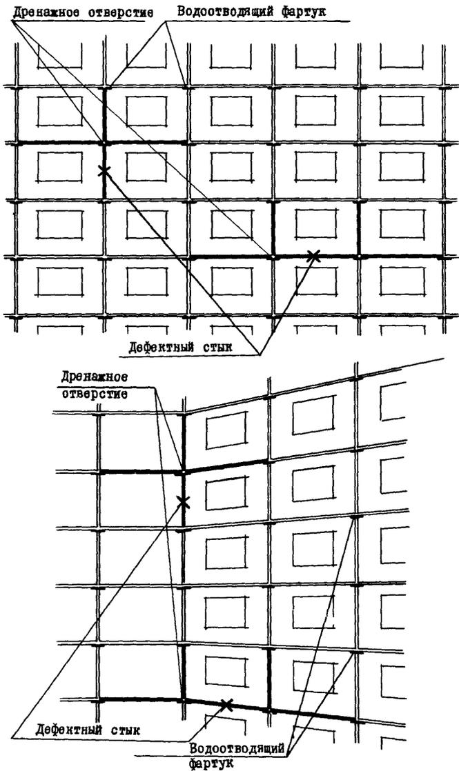
Рис. 1. Схема ремонта открытых стыков
