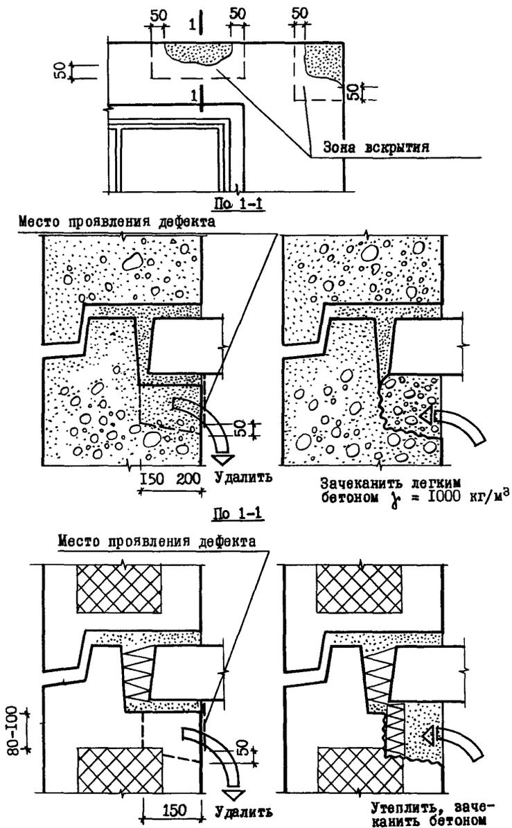
Рис. 2. Удаление теплопроводных включений в зоне стыка
