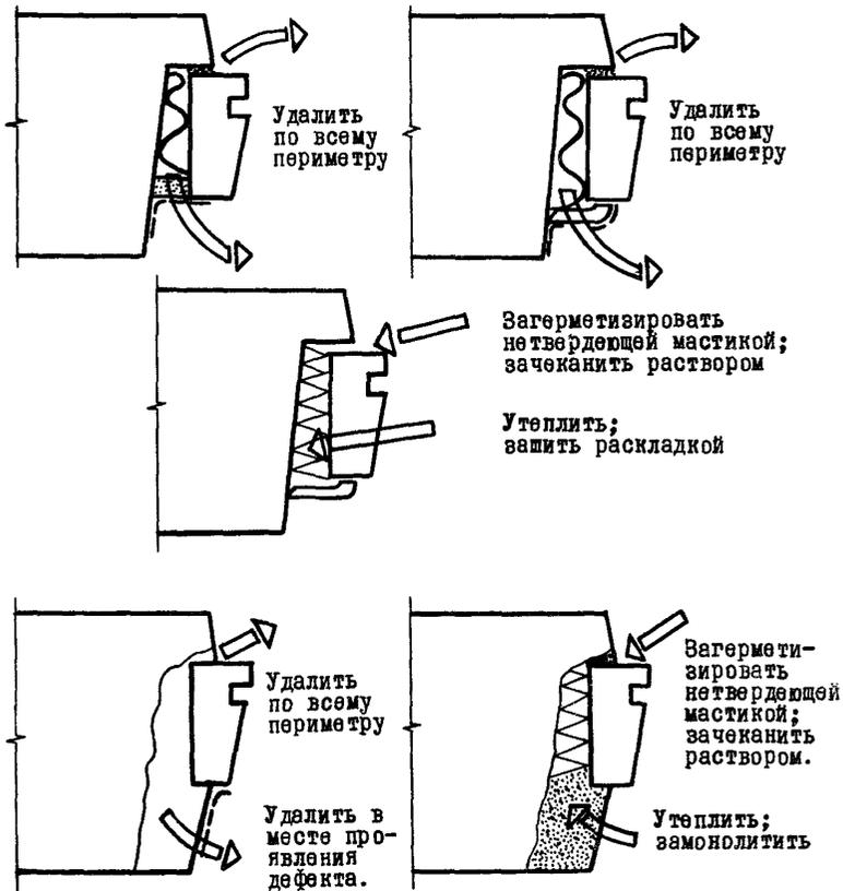
Рис. 8. Ремонт мест примыканий оконных заполнений к проемам со стороны помещений
