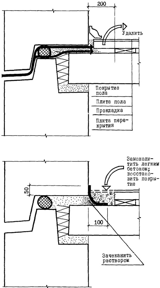
Рис. 4. Устройство дополнительной воздушной защиты горизонтальных стыков
