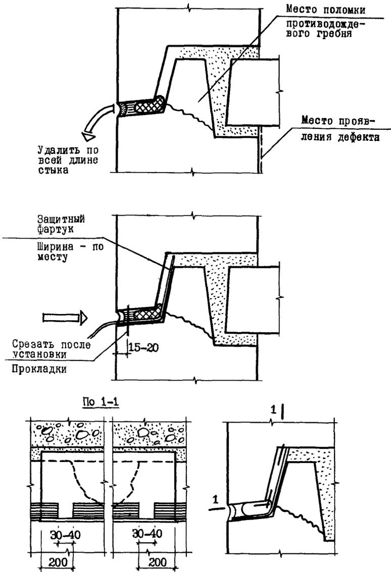
Рис. 3. Восстановление водозащитной функции противоодежного гребня
