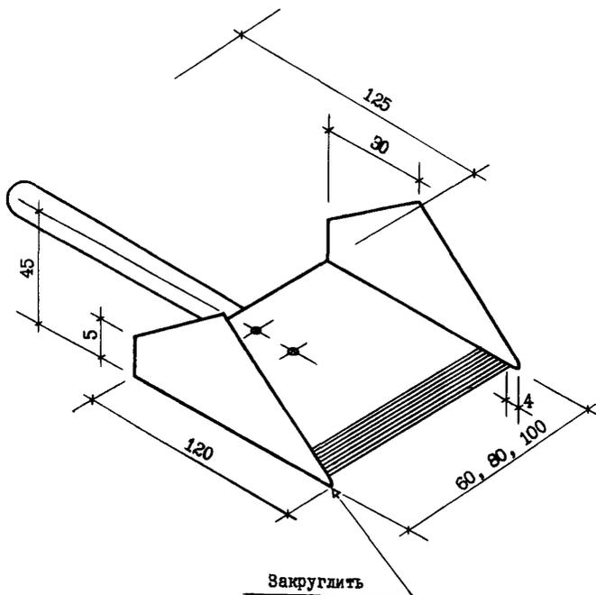
Рис. П.5. Калибровочный шпатель
