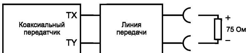
Рисунок 19 — Схема испытаний коаксиального передатчика
