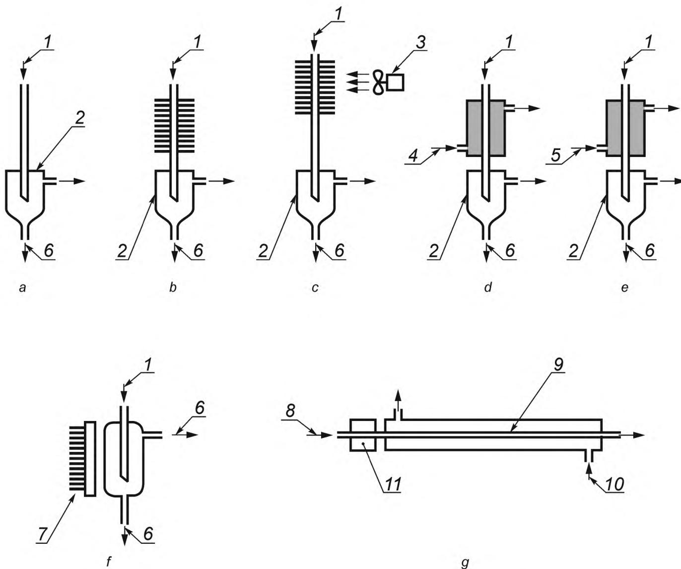
а — охлаждение до комнатной температуры; б — охлаждение до комнатной температуры; в — принудительное охлаждение воздухом; д — охлаждение водяной рубашкой; е — охлаждение хладагентом; ф — термоэлектрическое охлаждение; г — осушитель (полупроницаемый материал, тефлон или эквивалентные материалы)
