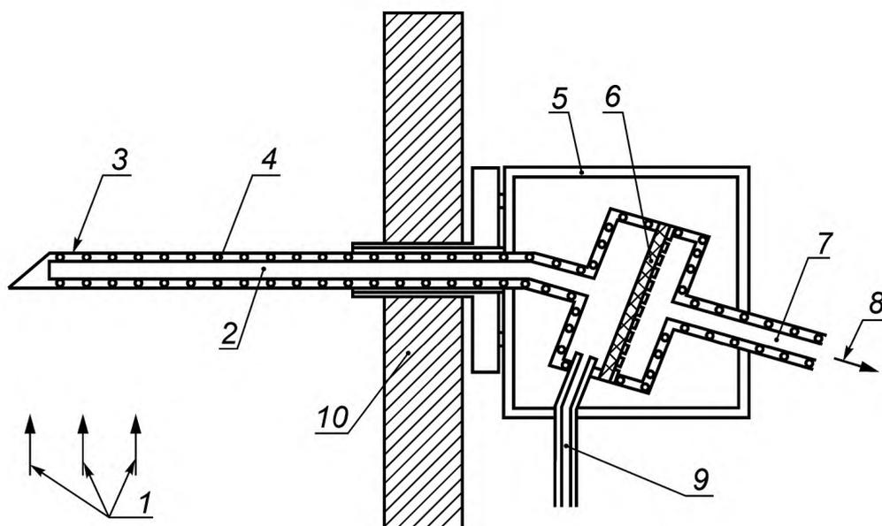
1 — поток отходящего газа; 2 — зонд; 3 — защитная трубка; 4 — нагреватель; 5 — водонепроницаемый кожух; 6 — фильтр; 7 — трубка для отбора проб; 8 — газ; 9 — трубка для подачи калибровочного газа; 10 — стенка газохода
