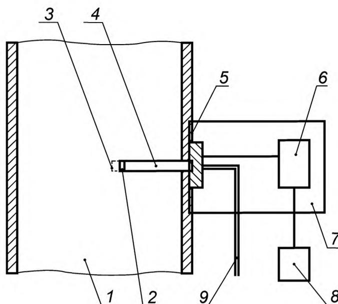
1 — газопровод или труба; 2 — измерительная ячейка; 3 — фильтр для защиты измерительной ячейки; 4 — зонд; 5 — крепление зонда; 6 — приемопередающий блок; 7 — защитный кожух; 8 — блок регистрации данных; 9 — трубка для подачи калибровочного газа
