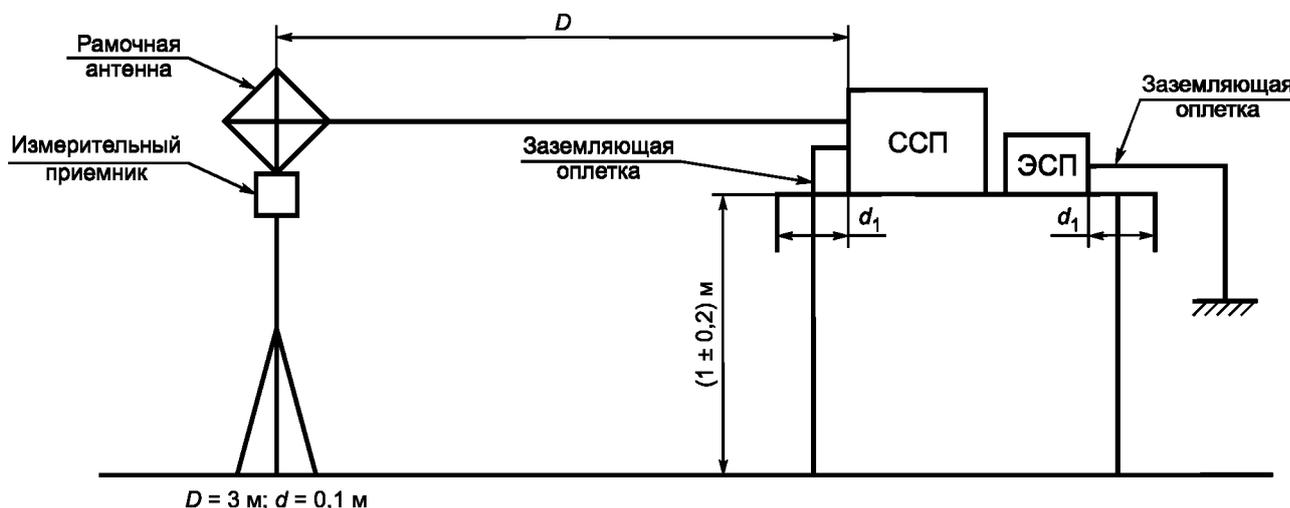
Рисунок В.1 — Установка для измерения магнитной составляющей напряженности поля
