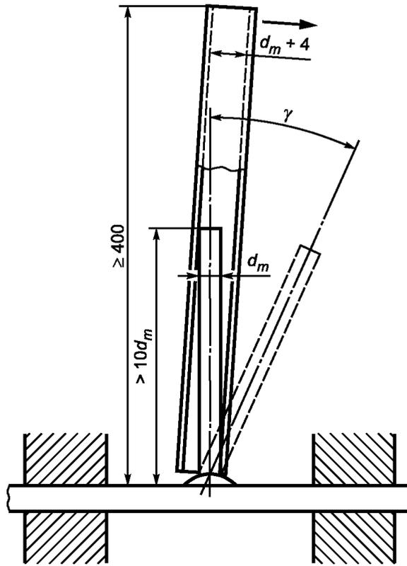
$d_n$  — номинальный диаметр испытуемого арматурного проката;  $d_m$  — максимальный размер поперечного сечения испытуемого арматурного проката;  $\gamma$  — угол загиба испытуемого арматурного проката
