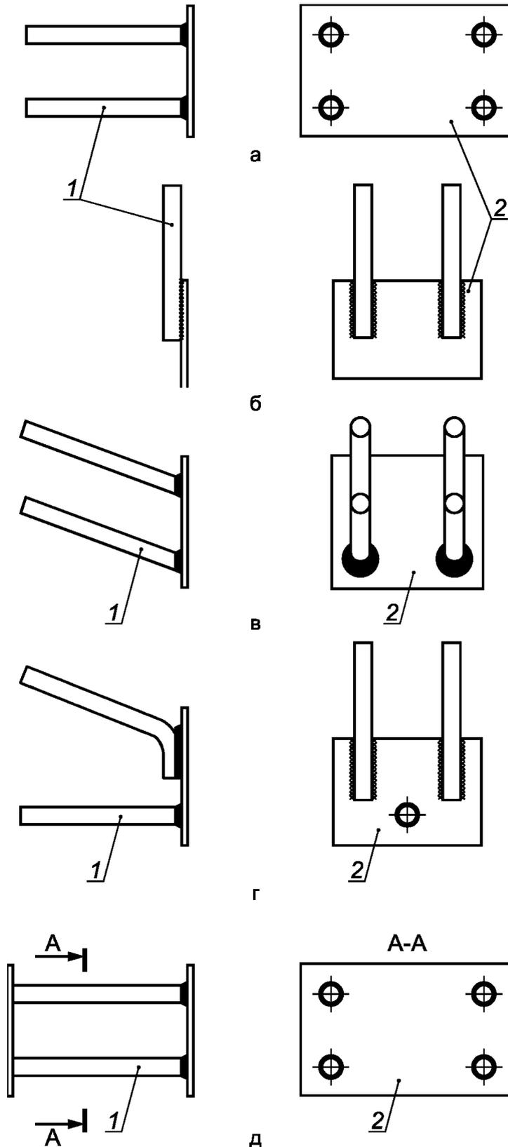
а, б, в, г — закладные изделия открытого типа (с перпендикулярным, параллельным, наклонным и смешанным расположением анкерных стержней соответственно); д — закладное изделие закрытого типа (с перпендикулярным расположением анкерных стержней); 1 — анкерные стержни; 2 — плоский элемент
