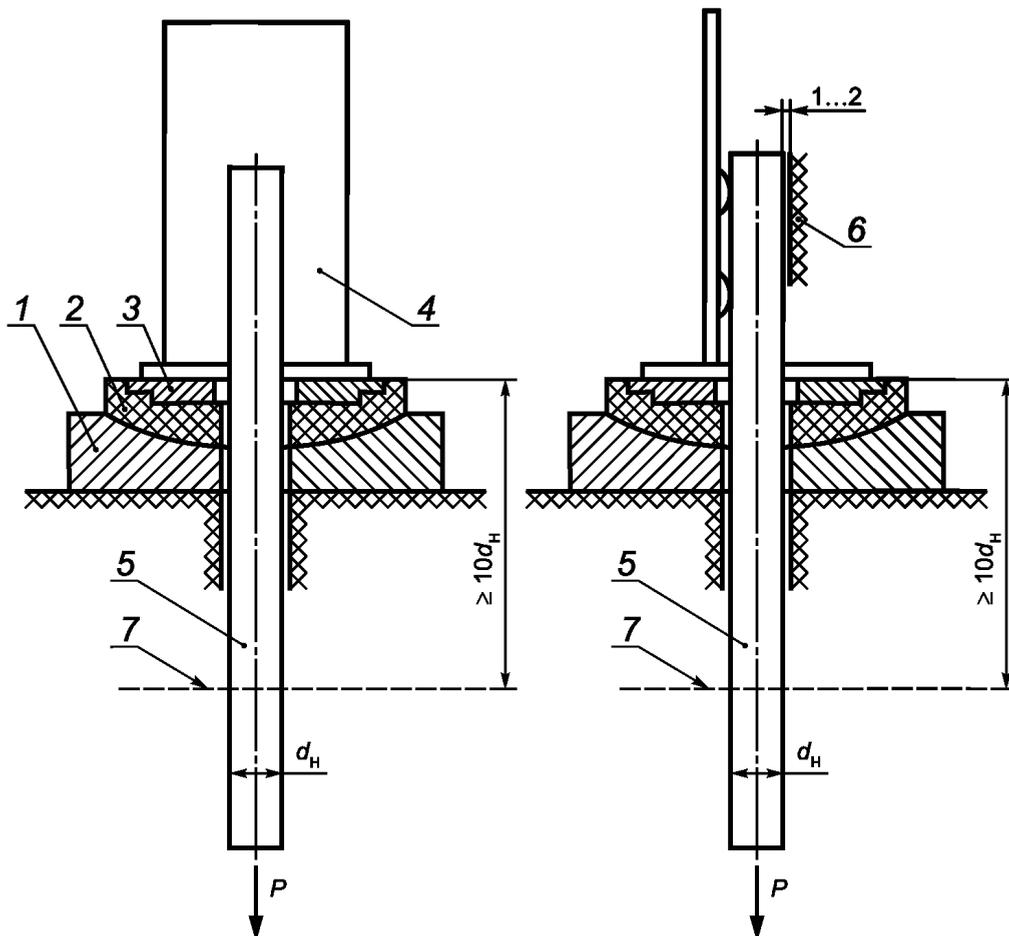
$d_n$  — номинальный диаметр анкерного стержня;  $P$  — испытательная нагрузка; 1 — сферическая опора; 2 — сферический вкладыш; 3 — сменное опорное кольцо; 4 — плоский элемент закладного изделия; 5 — анкерный стержень; 6 — упор, препятствующий изгибу образца; 7 — граница закрепления в захватах разрывной машины
