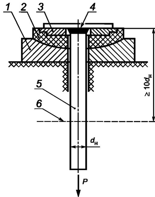
$d_n$  — номинальный диаметр анкерного стержня;  $P$  — испытательная нагрузка; 1 — сферическая опора; 2 — сферический вкладыш; 3 — сменное опорное кольцо; 4 — плоский элемент закладного изделия; 5 — анкерный стержень; 6 — граница закрепления в захвате разрывной машины
