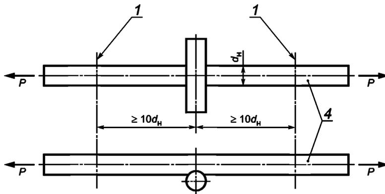
$d_n$  — номинальный диаметр рабочей арматуры;  $P$  — испытательная нагрузка;
