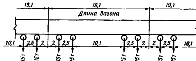
Рис. 3. Нормативная временная вертикальная нагрузка от подвижного состава метрополитена
