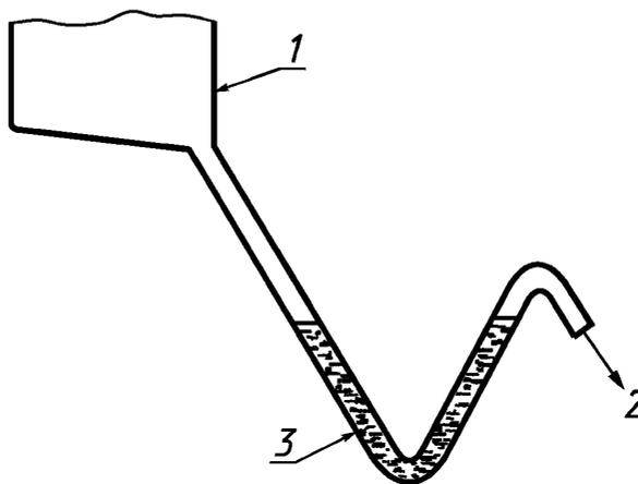
1 — распылитель; 2 — отходы; 3 — вода, образующая газовый замок
