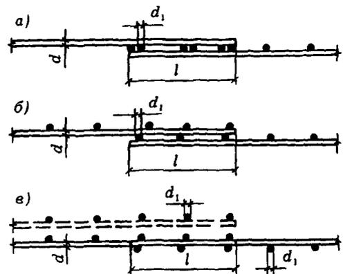
Черт. 24. Стыки сварных сеток внахлестку (без сварки) в направлении рабочей арматуры, выполненной из гладких стержней
