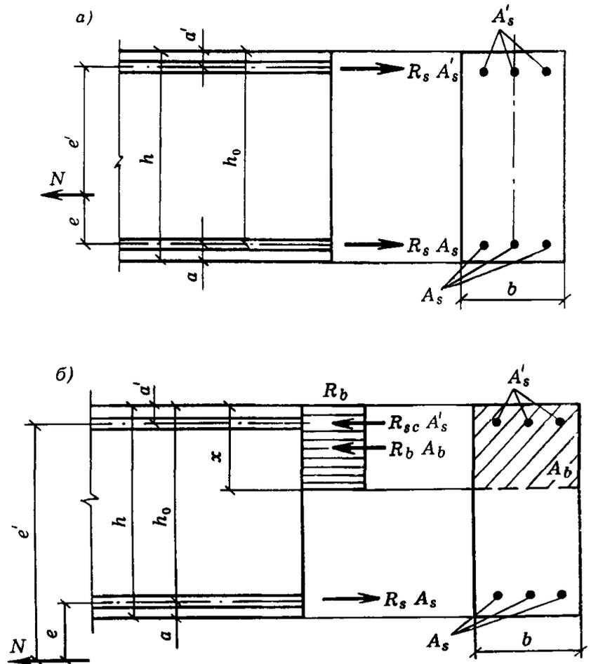
Черт. 7. Схема усилий и эпюра напряжений в сечении, нормальном к продольной оси внецентренно растянутого железобетонного элемента, при расчете его по прочности  $a$  — продольная сила  $N$  приложена между равнодействующими усилий в арматуре  $S$  и  $S'$ ;  $b$  — то же, за пределами расстояния между равнодействующими усилий в арматуре  $S$  и  $S'$
