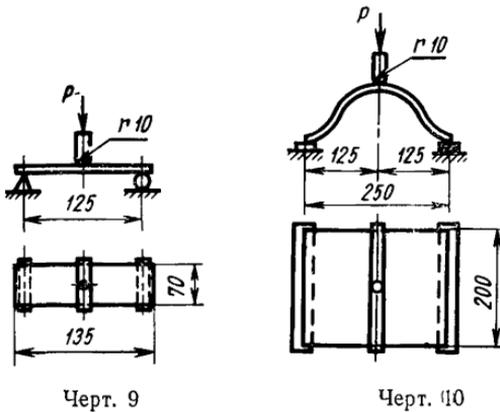
Ломающий груз делят на величину фактической длины образца (в сантиметрах), измеренную с точностью до 1 мм. Величину разрушающей нагрузки вычисляют как среднее арифметическое результатов испытания трех образцов.
