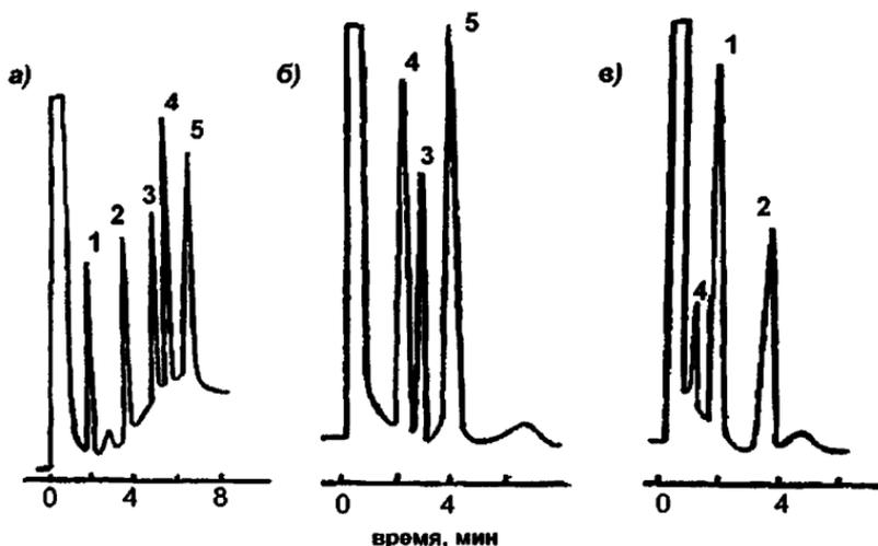
а) - в режиме программирования температуры колонки; б) и в) - в изотермическом режиме при температуре колонки 220 °С и 165 °С, соответственно;
