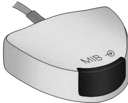
Рисунок D.3 — Настольный инфракрасный порт для ПК/ТД
