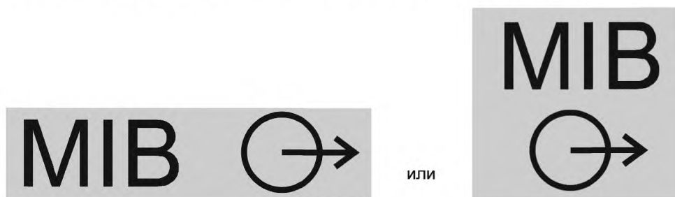
Рисунок D.1 — Маркировка канала медицинской информации (MIB) у порта КСП
