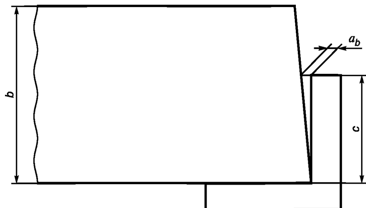
Рисунок 2 — Измерения отклонения от прямоугольности по длине и ширине
