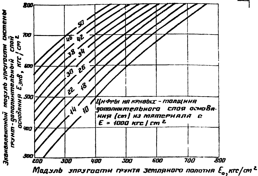
Рис. 33 Номограмма для определения эквивалентного модуля упругости системы грунт-дополнительный слой основания при расчетном автомобиле группы А
