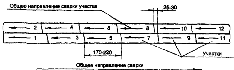
Рисунок 4.2 – Сварка швов способом двойного слоя
